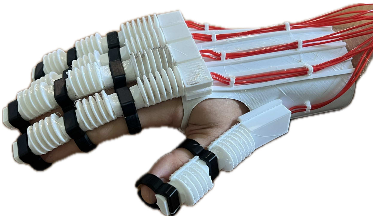
Slika 5.15. Isprintani model rukavice za rehabilitaciju postavljen na šaku korisnika.
