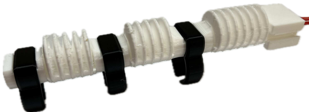
Slika 5.11. Isprintani modeli prstenja za prihvat postavljeni na mekog robota.
