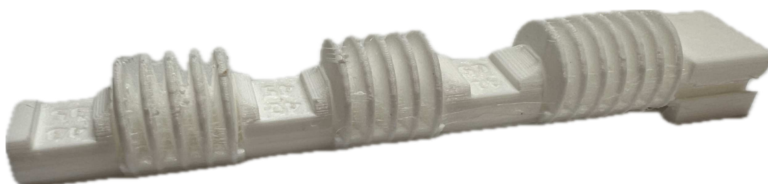
Slika 5.8. Isprintani model mekog robota.
