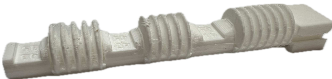
Slika 5.8. Isprintani model mekog robota.
