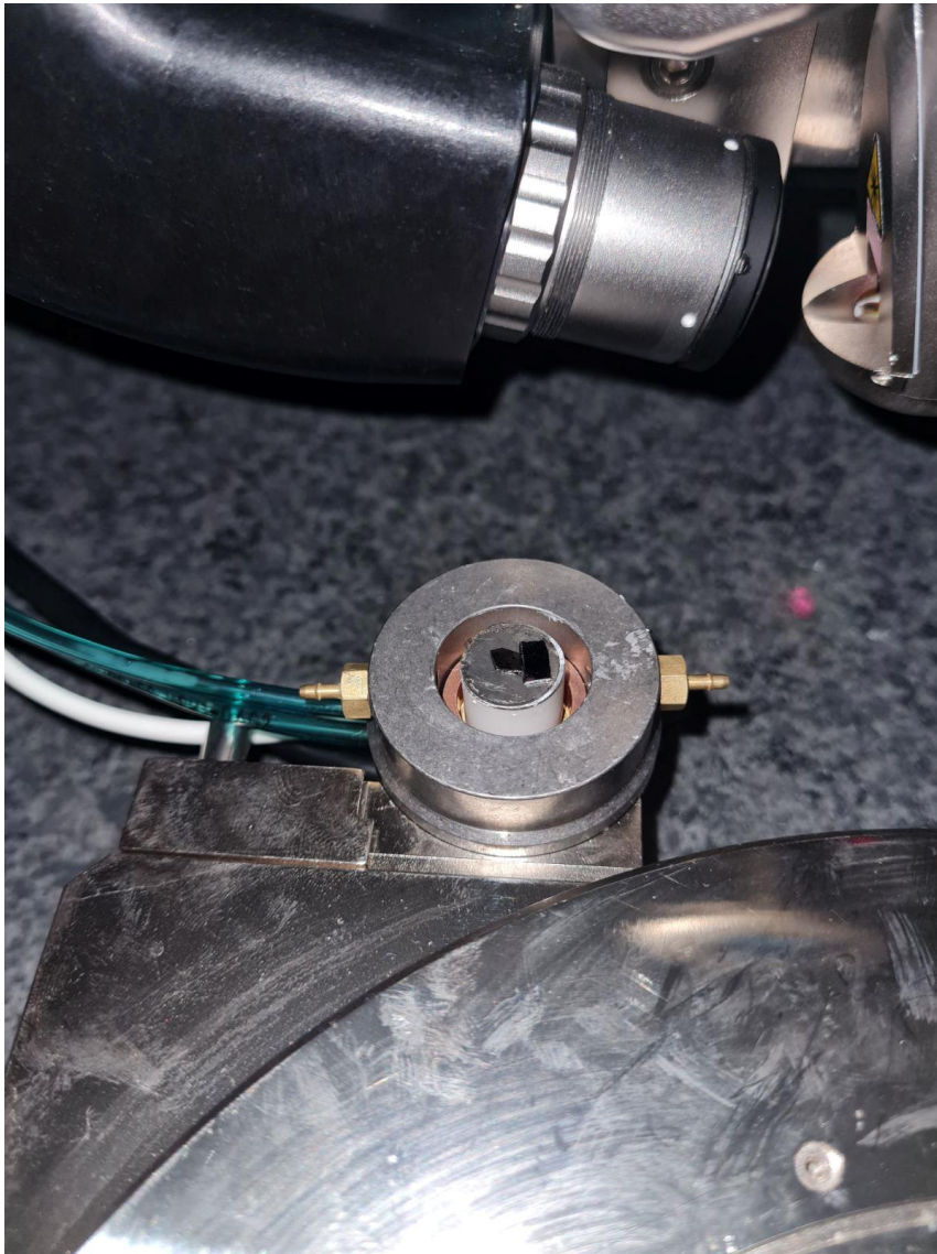
Slika 5.5: Uzorci aluminijevog oksida i nehrđajućeg čelika na grijaču
