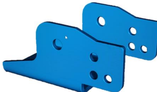
Slika 2.11 Rezultat skeniranja (sken) elementa "Šarka 2"
