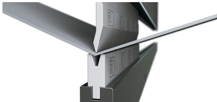
Slika 9.2 Postupak savijanja limova [14]
