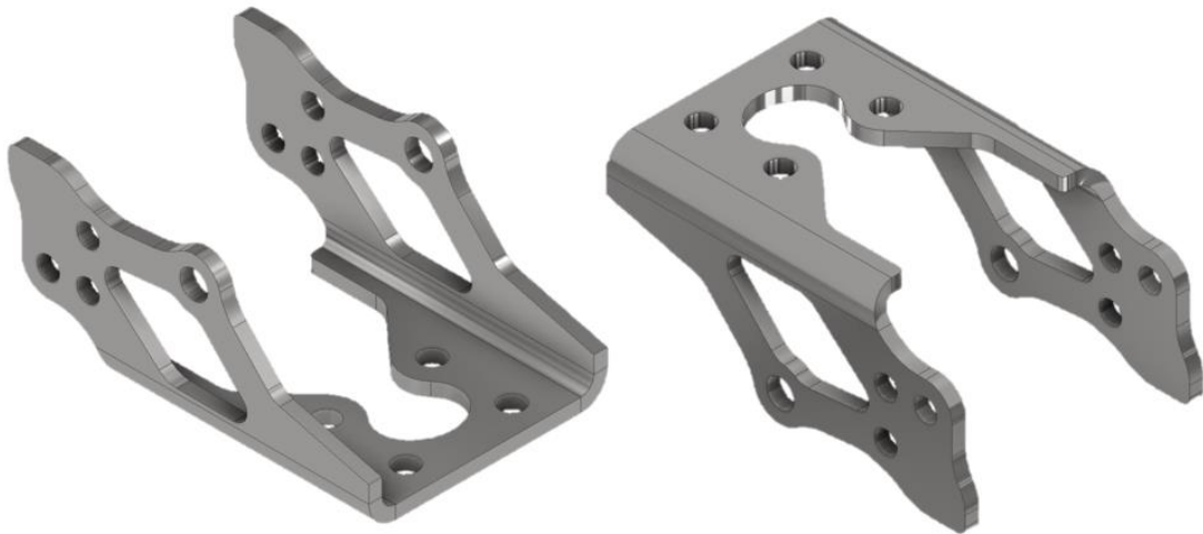
Slika 9.6 Optimizirani geometrijski model elementa „Šarka 2“ („Sheet Metal“)
