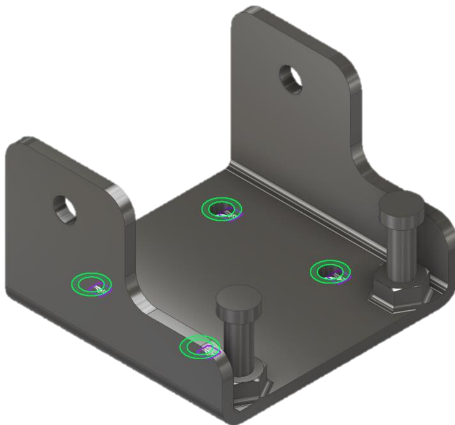
Slika 7.8 Aplikirani oslonci na element „Šarka 1“ (optimizacija topologije)
