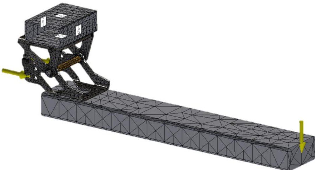
Slika 8.3 Naredba "Local Mesh Control"
