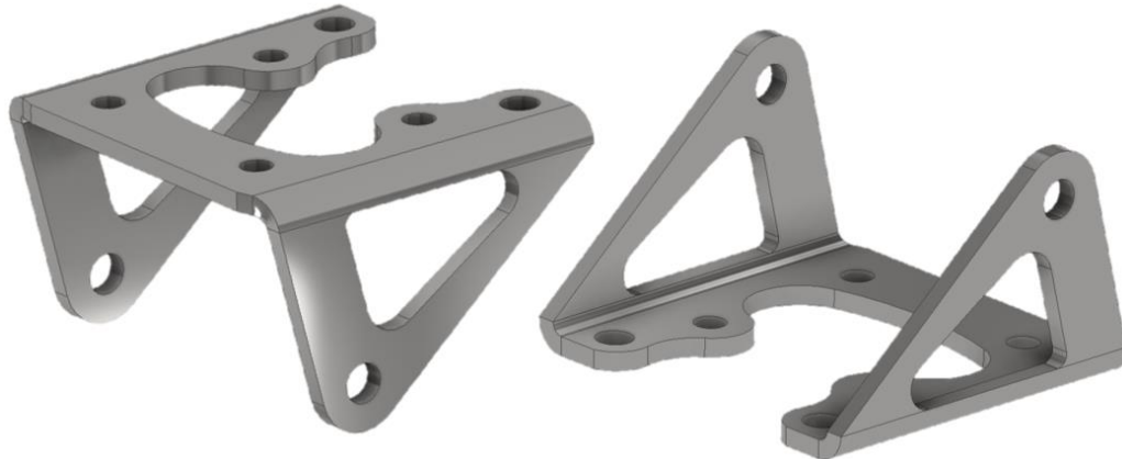
Slika 9.4 Optimizirani geometrijski model elementa „Šarka 1“ („Sheet Metal“)
