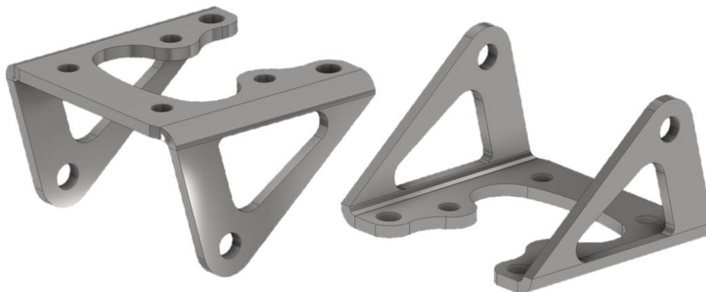
Slika 9.4 Optimizirani geometrijski model elementa „Šarka 1“ („Sheet Metal“)
