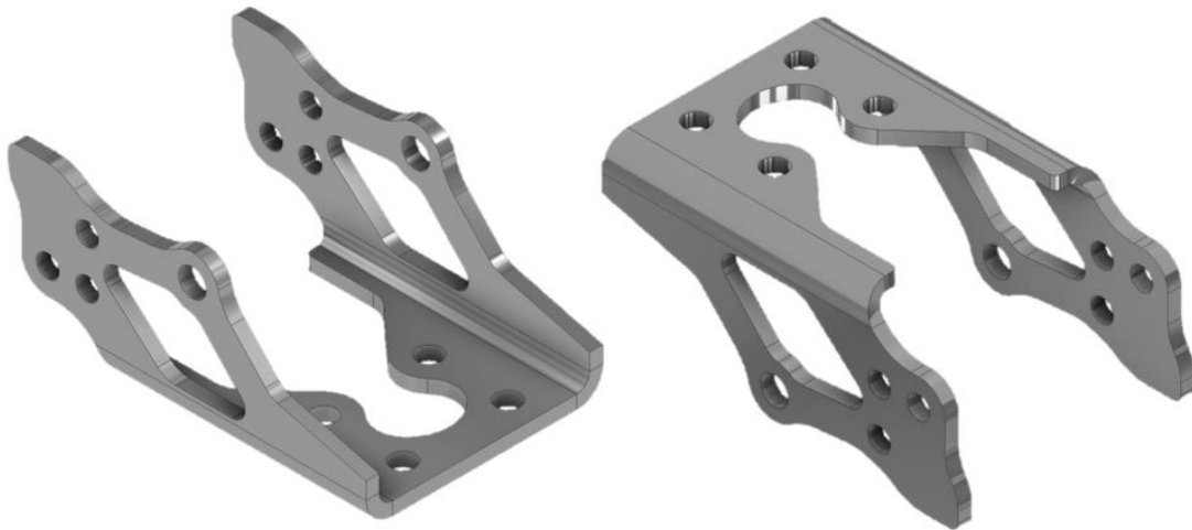
Slika 9.6 Optimizirani geometrijski model elementa „Šarka 2“ („Sheet Metal“)
