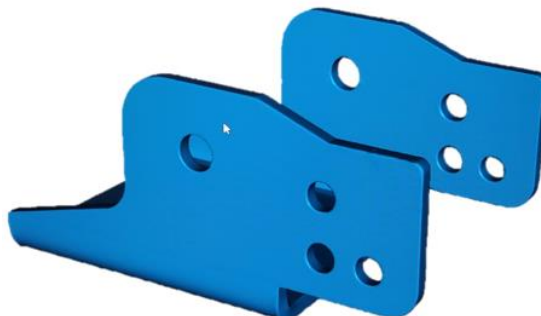
Slika 2.11 Rezultat skeniranja (sken) elementa "Šarka 2"
