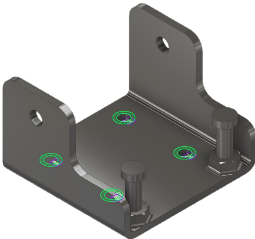
Slika 7.8 Aplicirani oslonci na element „Šarka 1“ (optimizacija topologije)
