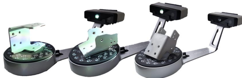
Slika 2.10 Položaji elementa "Šarka 2" prilikom skeniranja
