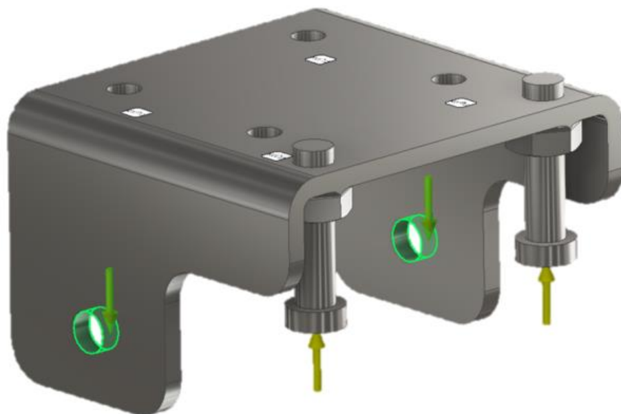
Slika 7.11 Aplicirane sile na element „Šarka 1“ (optimizacija topologije)
