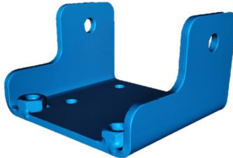
Slika 2.9 Rezultat skeniranja (sken) elementa "Šarka 1"
