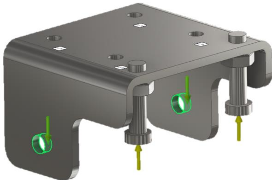
Slika 7.11 Aplicirane sile na element „Šarka 1“ (optimizacija topologije)
