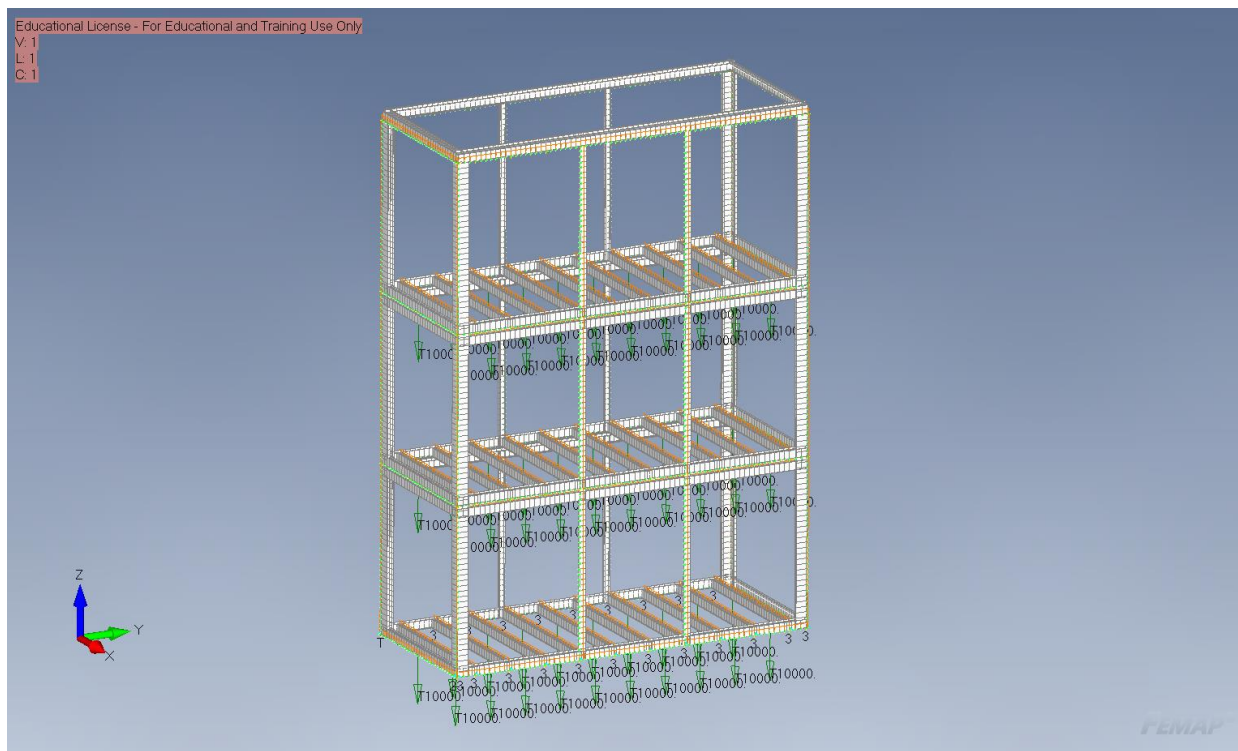
Slika 8.4. Kontejneri sa opterećenjima na podnim omega profilima
