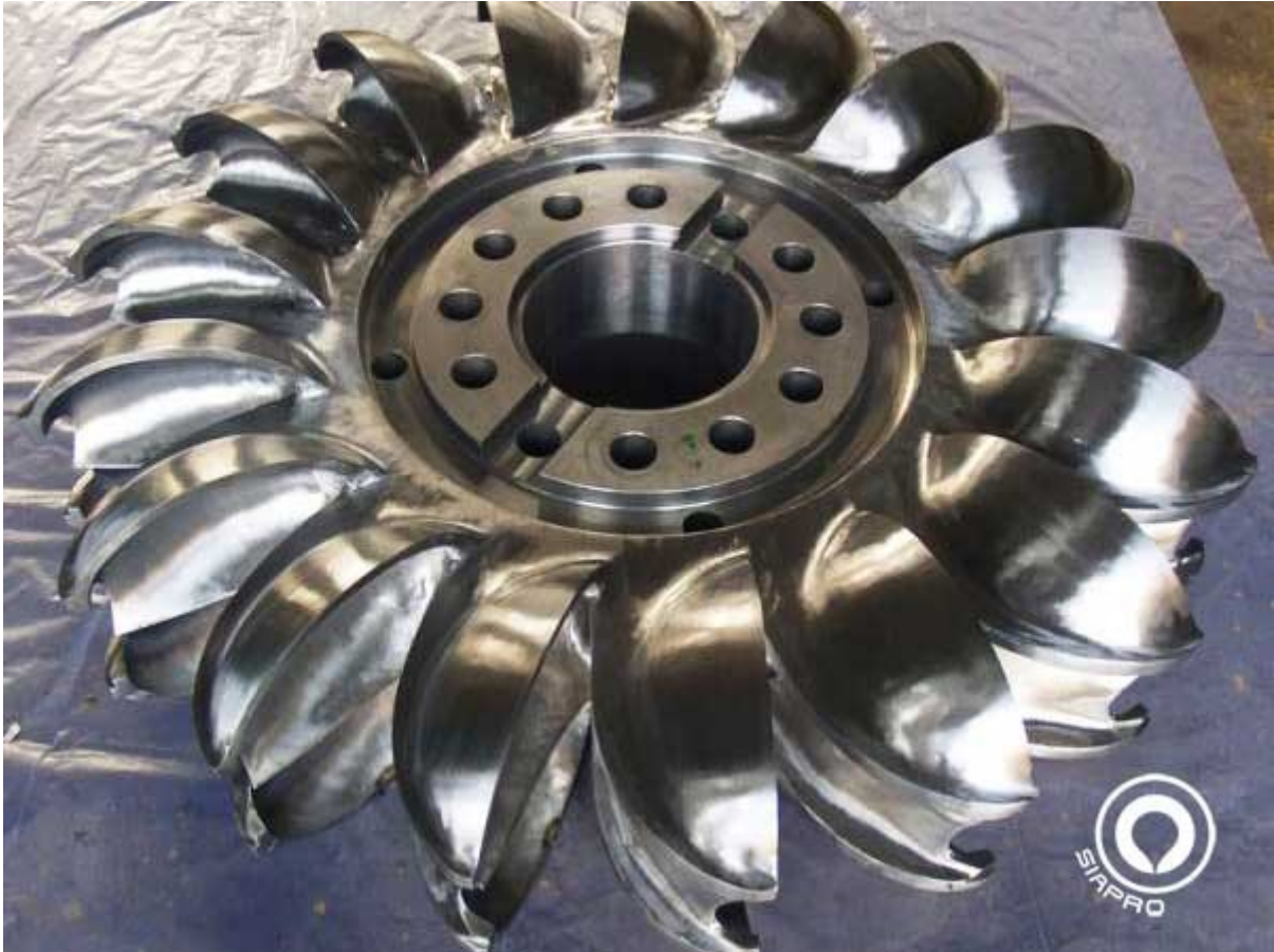
Slika 4.2. Turbina velikog promjera sa 20 lopatice [13]
