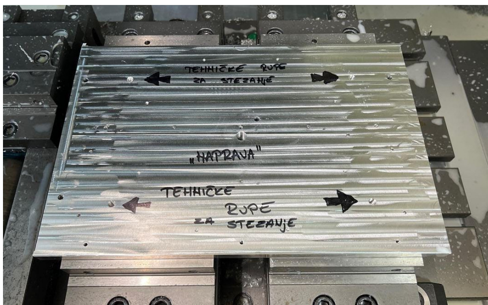
Slika 7.1.13. Prikaz tehničkih rupja za stezanje pozicije 3
