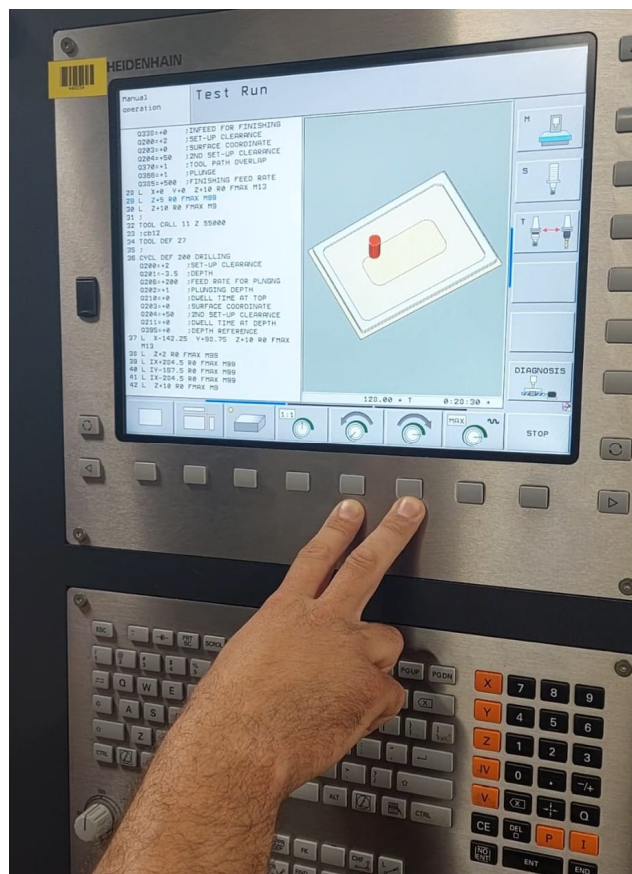
Slika 7.1. Ručno programiranje na upravljačkoj jedinici Heidenhain TNC 640
