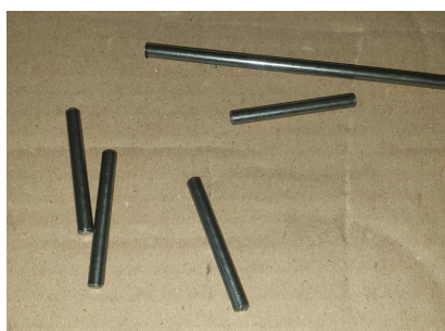
Slika 8.2. Pozicija 8 – Vodilice izrađene od čelične šipke
