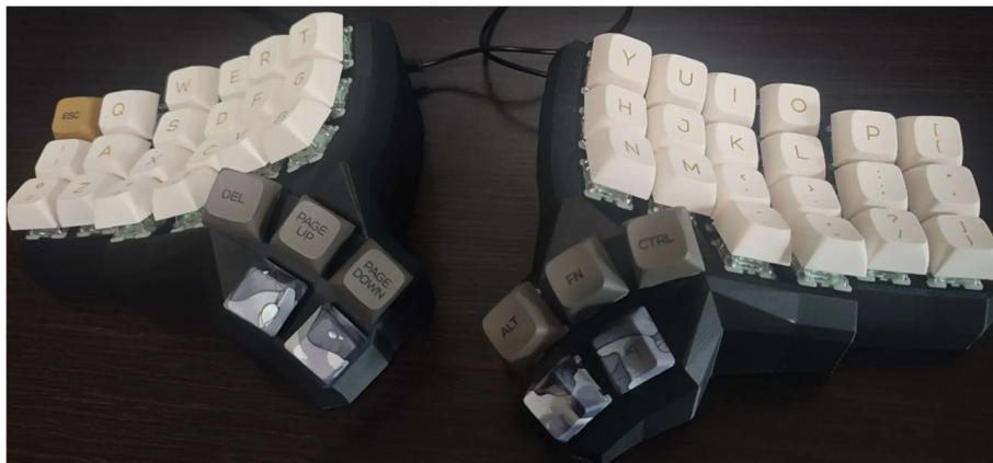
Slika 5.5.1. Prikaz poklopaca tipkala s otiskom [1]
