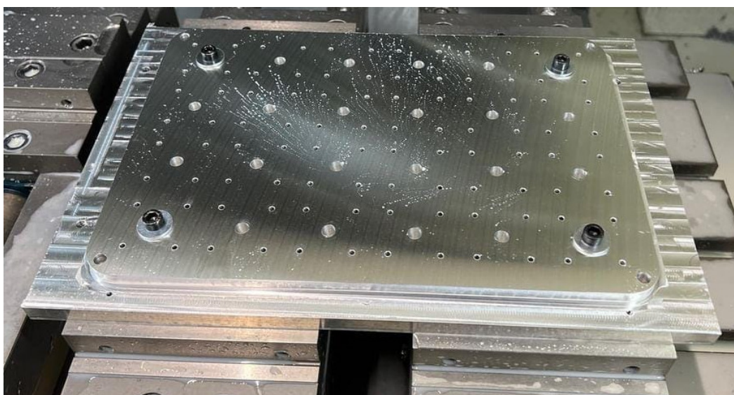
Slika 7.1.17. Finalni prikaz matrice prije skidanja sa stroja
