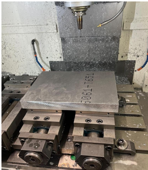
Slika 7.1.2. Umjeravanje alata prije početka tehnološkog postupka glodanja
