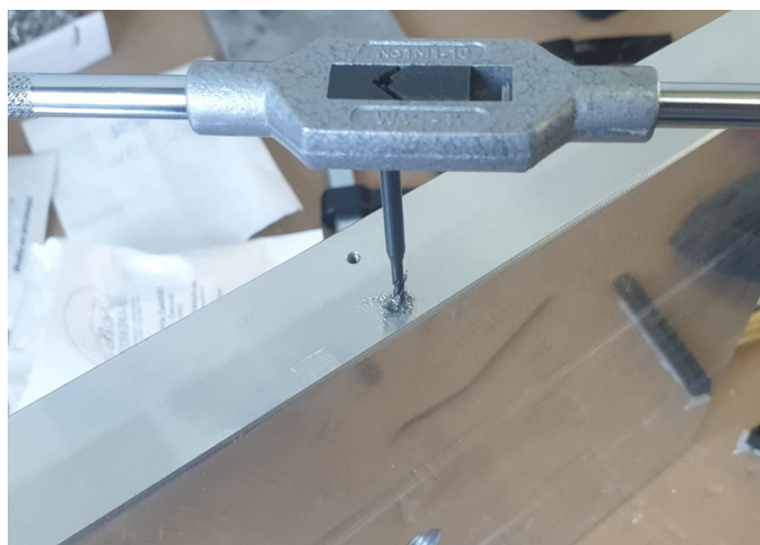
Slika 8.8. Urezivanje navoja u poziciju 1
