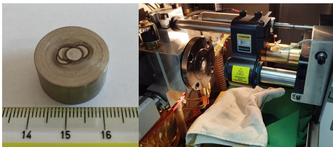
Slika 5.2 Uzorak na kojem je izvršeno ispitivanje kemijskog sastava i komora uređaja za ispitivanje kemijskog sastava materijala LECO GDS 500A
