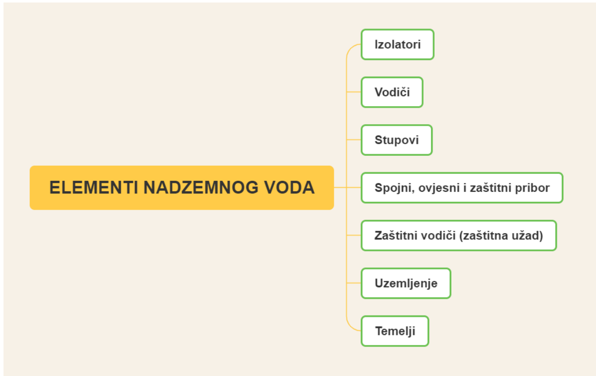
Slika 2.3 Glavni elementi nadzemnog vod
