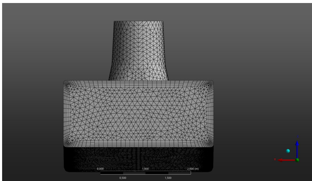
Slika 7.6 Inflacija izlaznog presjeka difuzora
