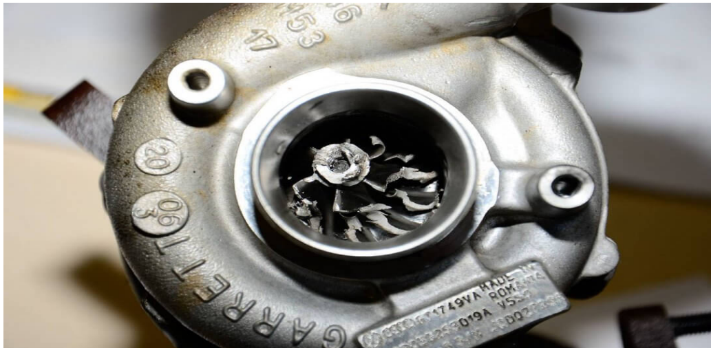
Slika 5.3. Oštećenje lopatica turbopuhala
