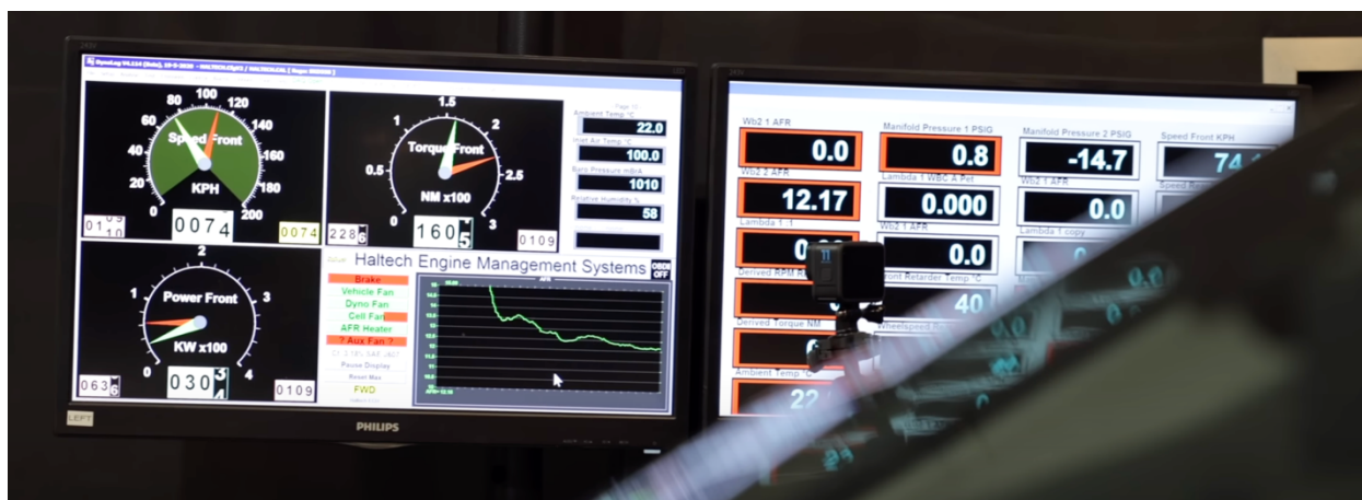
Slika 6.11. Praćenje parametara prilikom testiranja turbopuhala
