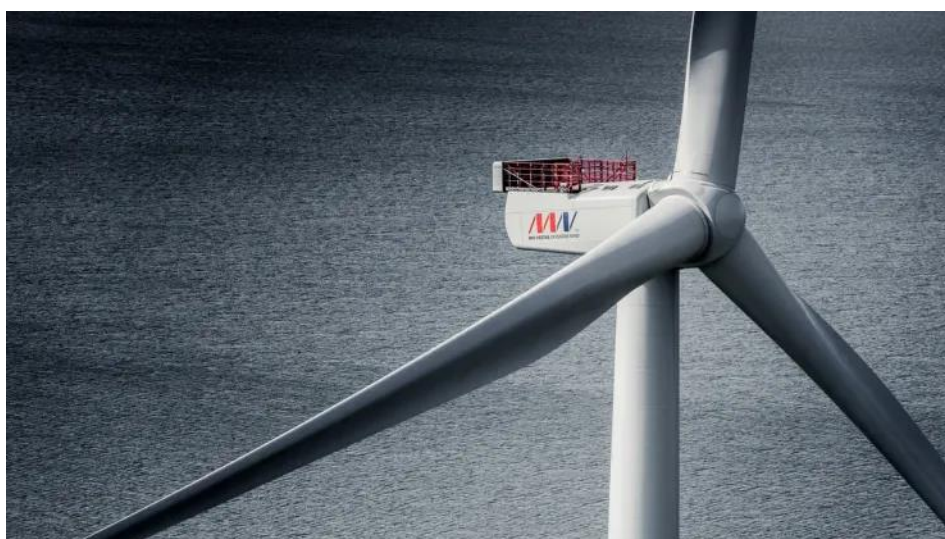
Slika 3.5. Priobalna vjetroturbina V164-10.0 proizvođača MHI Vestas [13]
