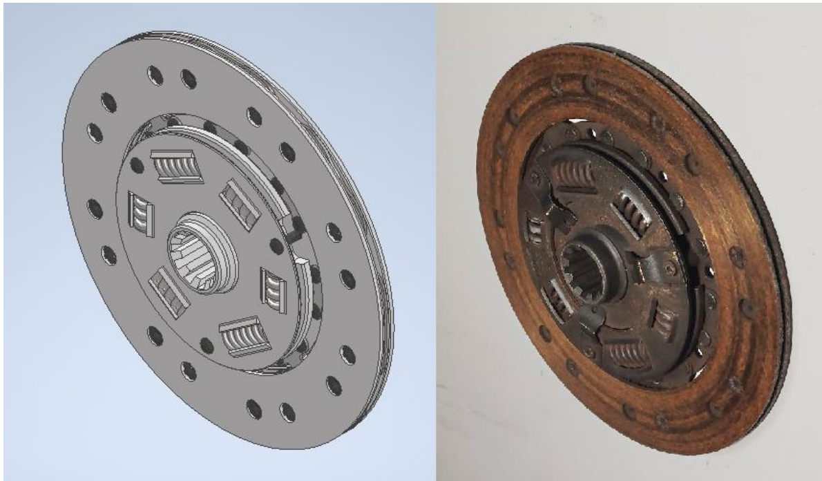
Slika 3.11: Usporedba prednje strane redizajnirane lamele sa postojećom
