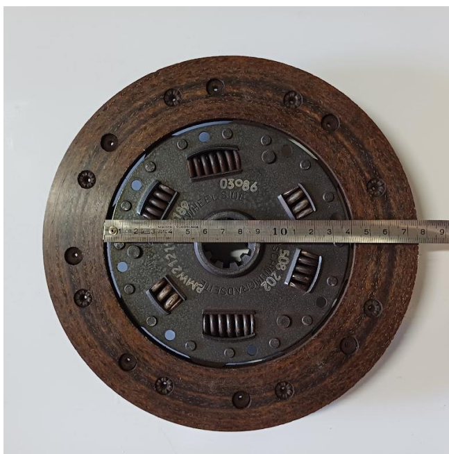
Slika 2.2 Mjerenje unutarnjeg promjera lamele
