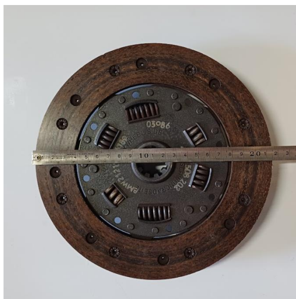
Slika 2.1 Mjerenje vanjskog promjera lamele
