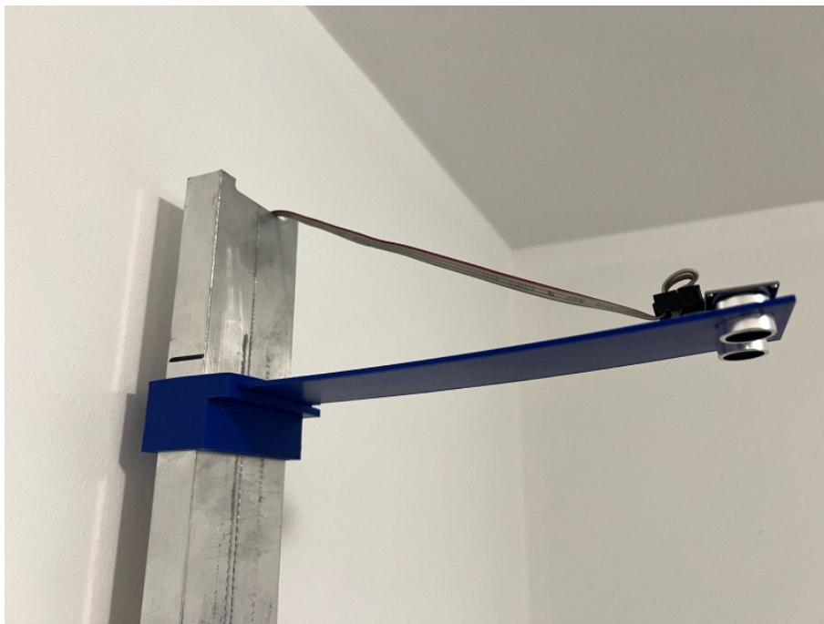
Slika 5.1 HC-SR04 modul i pripadajući nosač
