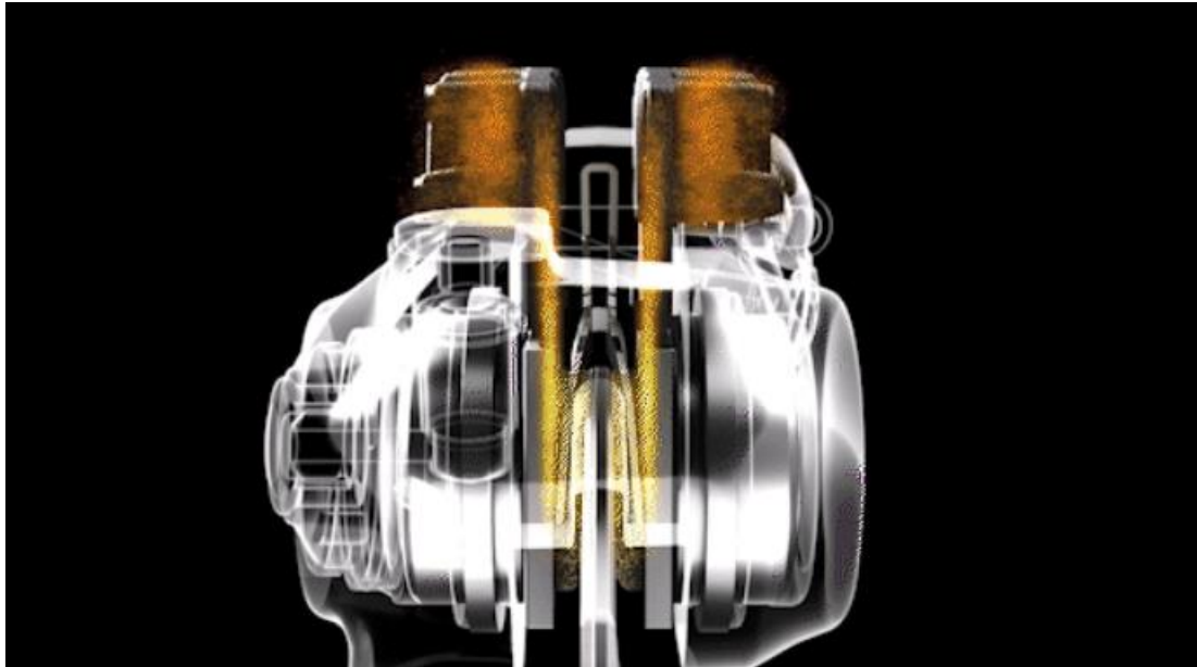
Slika 4.25. Cirkulacija toplog zraka kroz kočnicu [20]
