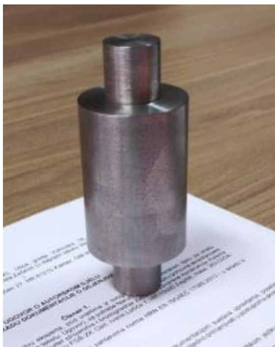
Slika 6.1. Strojni dio OZ.24 - ST.74 izrađen iz čelika C45E
