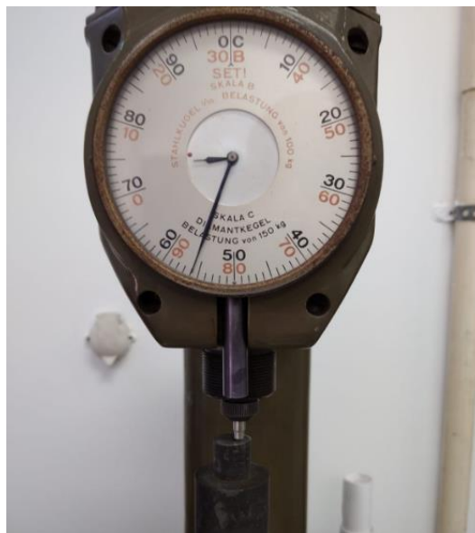
Slika 6.6. Tvrdoća strojnog dijela nakon kaljenja
