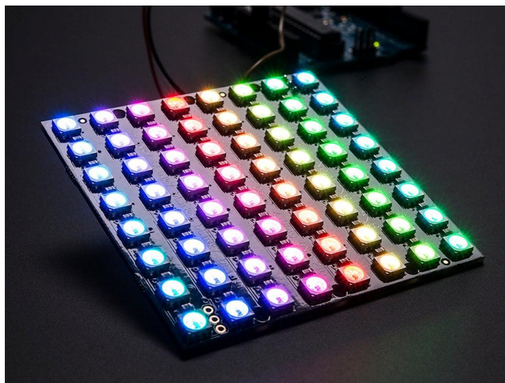
Slika 5.1. Adafruit NeoPixel modul WS2812B-64.
