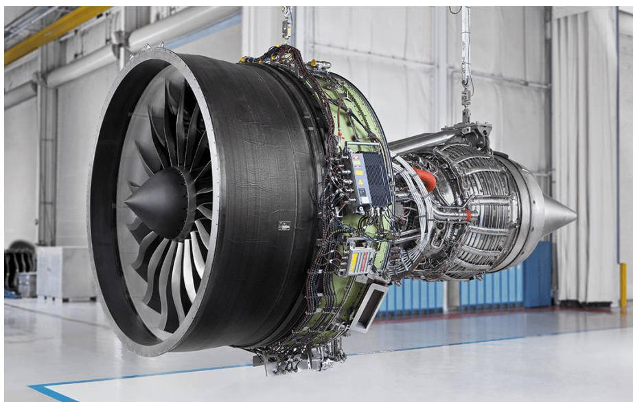
Slika 3.1. GENX -1B turboventilatorski motor [12]
