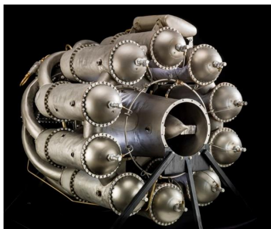
Slika 2.4. Power Jet W.1 mlazni motor [5] s presjekom [6]
