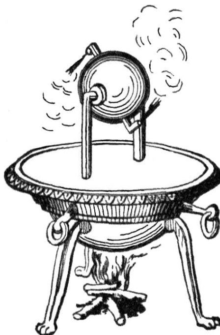
Slika 2.1. Aeolipile – Heronova kugla [1]
