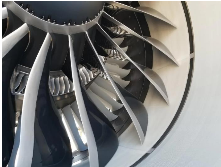
Slika 3.5. Ventilator GEnX motora s varijabilnim ulaznim sprovodnim lopaticama (Inlet Guide Vanes – IGV) [17]
