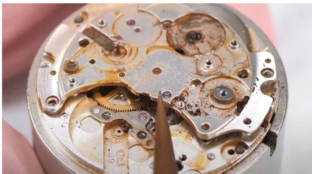
Slika 41- Prikaz korozije na satnom mehanizmu [50]
