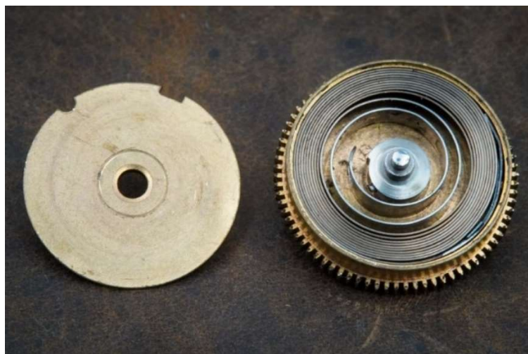
Slika 9- Spiralna opruga u kućištu [26]
