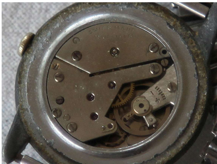
Slika 42- Prikaz korozije na poleđini kućišta [54]
