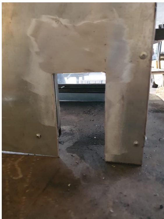
Slika 5.16. Otvor za cijev hlađenja histerezne kočnice
