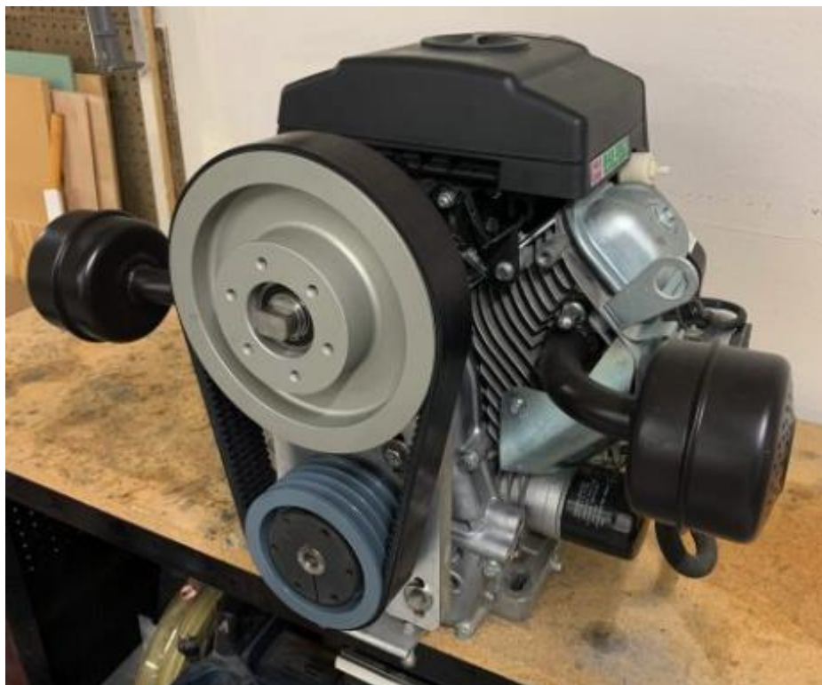
Slika 1.2 Stroj s remenim prijenosom [2]
