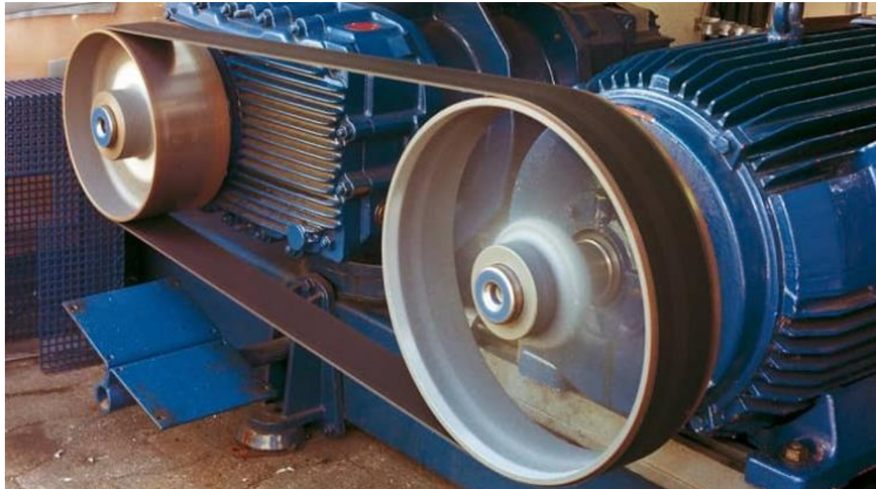
Slika 1.3 Stroj s plosnatim remenom [4]
