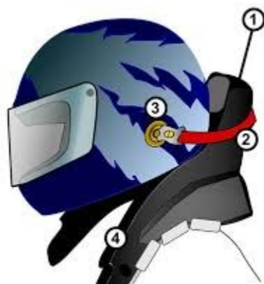
Slika 2.3 Skica HANS uređaja za zaštitu vrata vozača [6]
