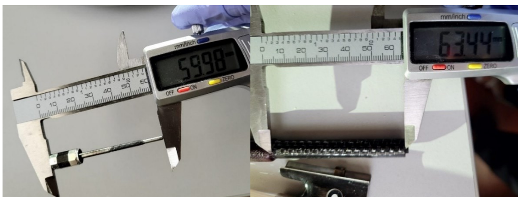
Slika 3.11 Mjerenje štapa i vijka gudala pomičnim mjerilom
