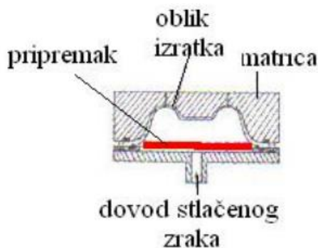
Slika 3.4 Postupak toplog oblikovanja stlačenim zrakom u matrici [7]
