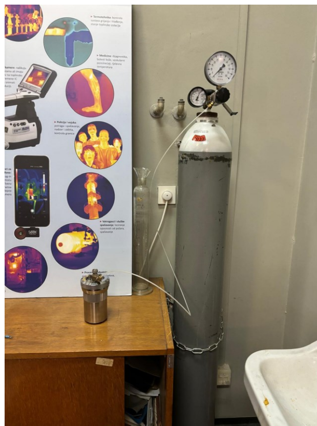
Slika 8 Prikaz punjenja kalorimetrijske bombe kisikom
