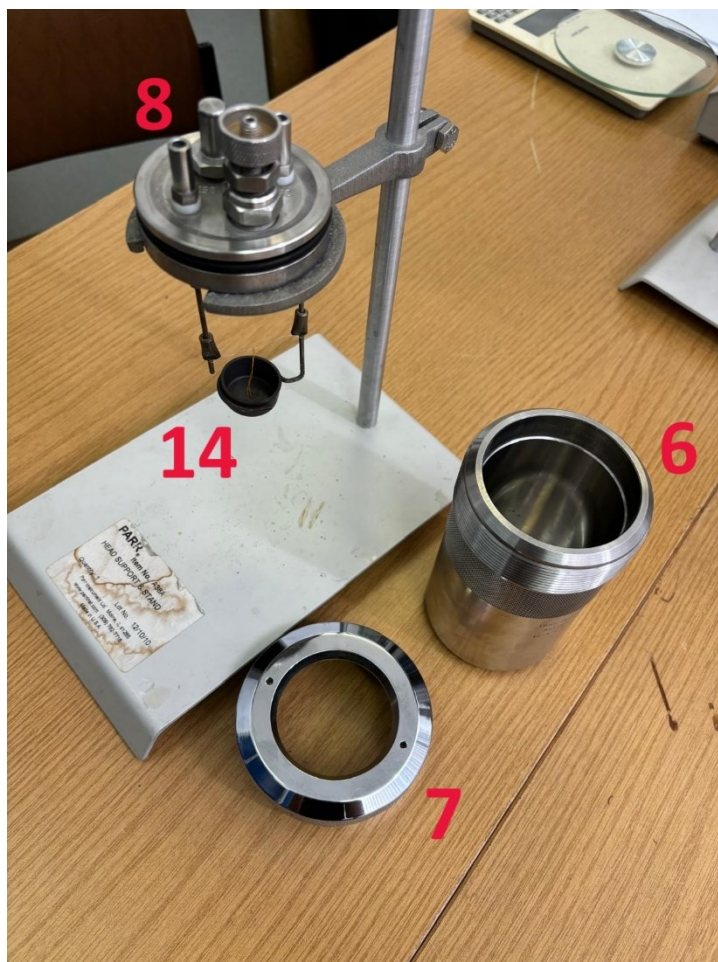
Slika 4 Dijelovi kalorimetrijske bombe sa postavljenom posudicom za uzorak
