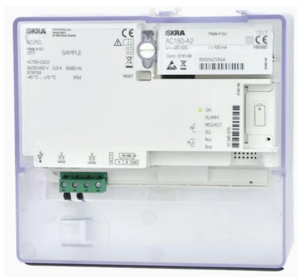
Slika 6.9. Koncentrator AC750 proizvođača Iskraemeco [10]
