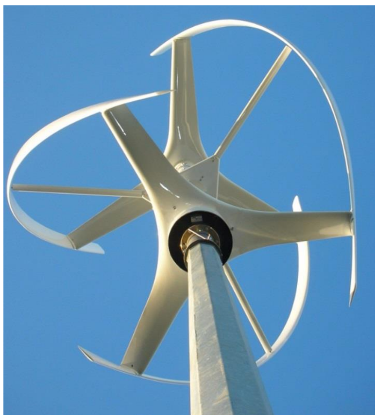
Slika 2.11. Spiralni rotor "Qr6" [15]
