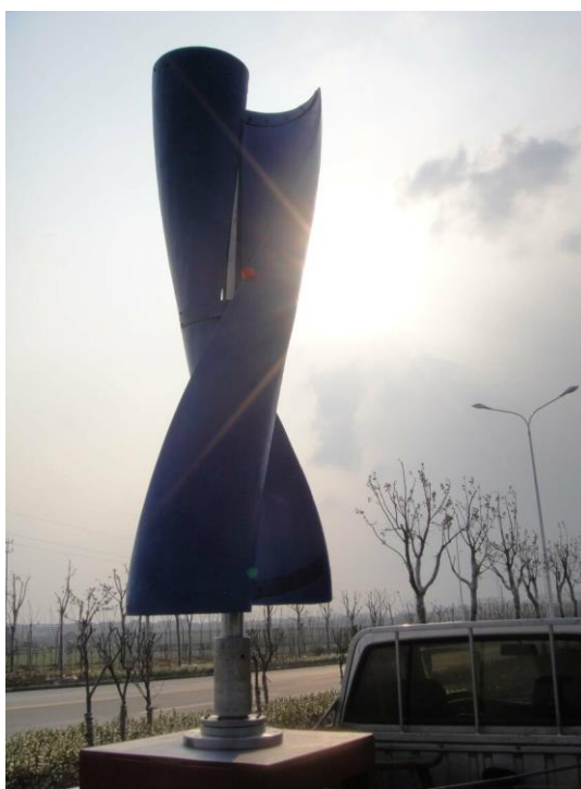
Slika 2.7. Spiralni Savonius rotor [10]
