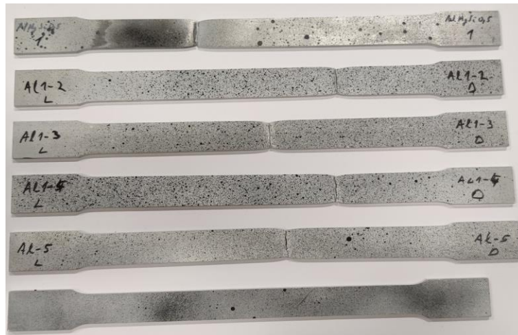
Slika 5.31. Komplet polomljenih ispitnih uzoraka legure aluminija Al1 - AlMgSi0,5 debljine 5 mm
