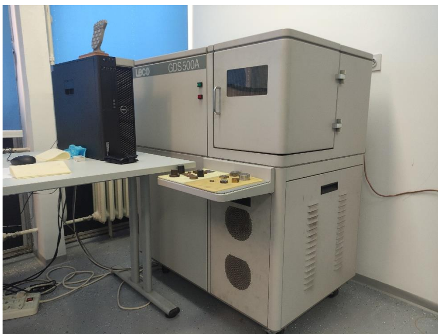
Slika 4.7. LECO GDS500A spektrometar
