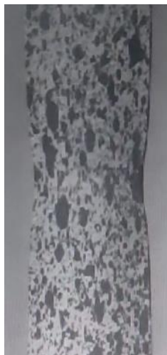
Slika 2.8. Smanjenje površine poprečnog presjeka (engl. Necking)-čelik AISI 304
