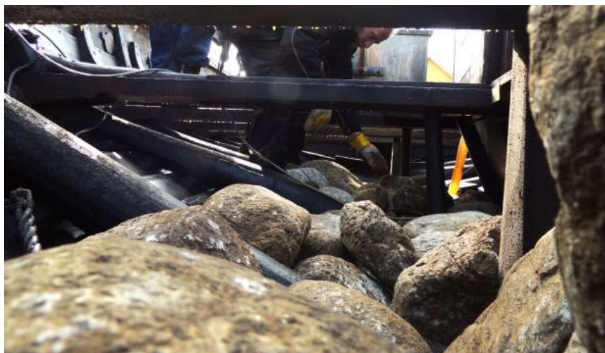
Slika 3.2 Dno vikinškog broda ispunjeno balastom u obliku kamenja [32]
