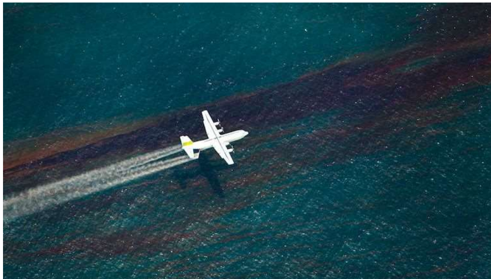
Slika 3.11 Zračno ispuštanje raspršivača nafte [72]
