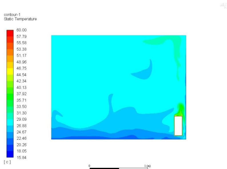
Slika 7.13 Raspodjela temperatura nakon 15 minuta za slučaj 3 (radijator temperature 60°C)
