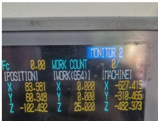
Slika 6.6. Pomicanje stroja u nultu točku
