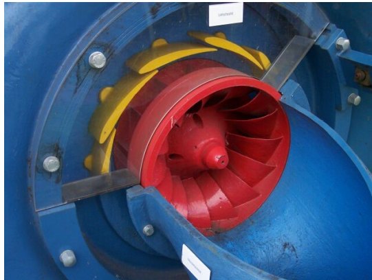
Slika 2-4 Unutrašnjost Francisove turbine
