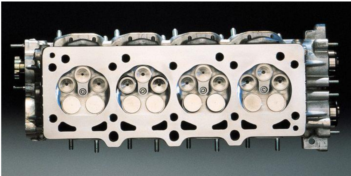
Slika 2.4. Konfiguracija s pet ventila po cilindru [6]
