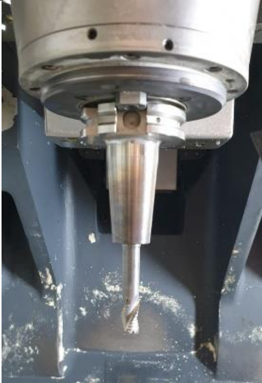
Prikaz alata u CNC glodalici
