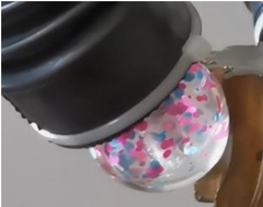
Slika 3.2.1. Točkasti prihvat kuglica i objekta hvatanja
