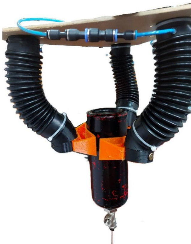
Slika 5.2.4. Hvataljka sa tri aktuatora
