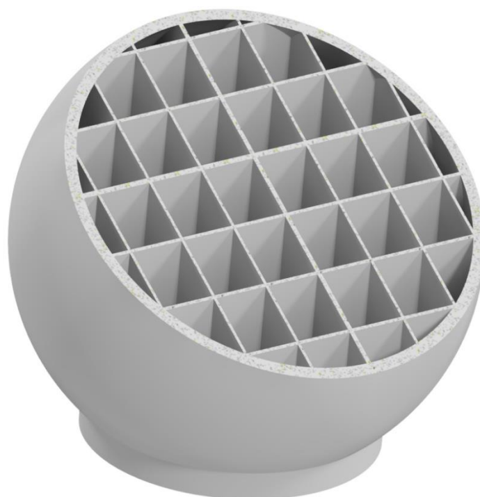
Slika 5.3.5. Kuglasti prihvat sa rešetkastom strukturom
