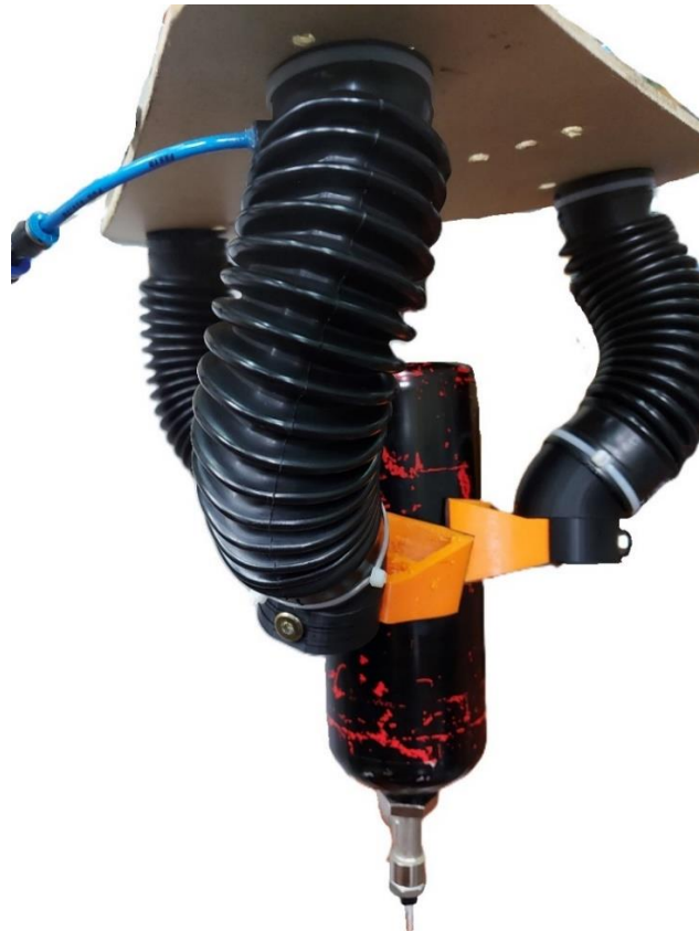
Slika 5.3.2. Deformacija hvataljke sa 3 aktuatora
