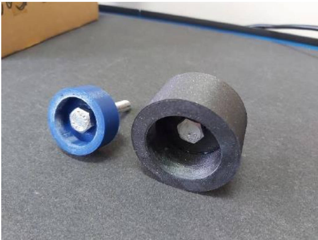
Slika 3.1.3. Čepovi za brtvljenje [4]
