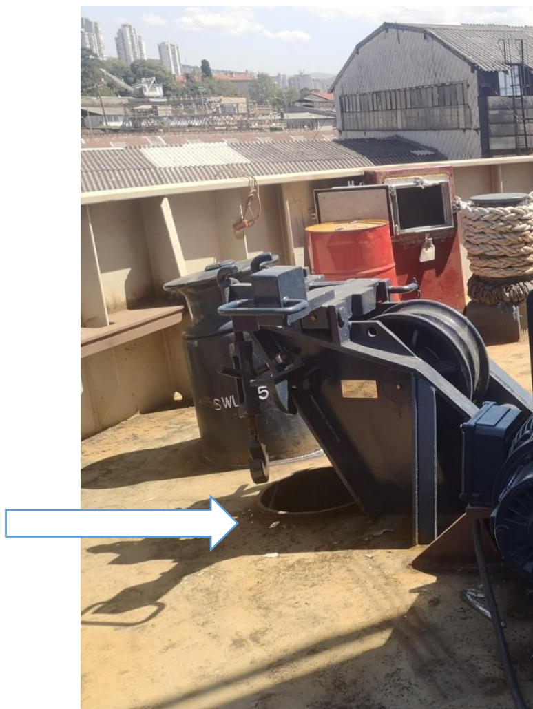
Slika 5.2 Sidreno ždrijelo na palubi
