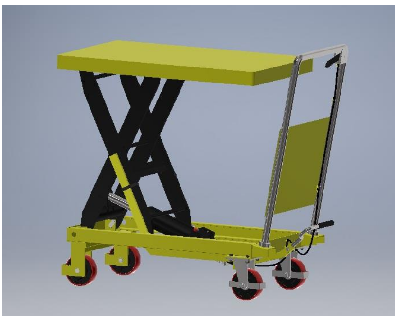
Slika 4.37. Krajnje izdignuti položaj platforme
