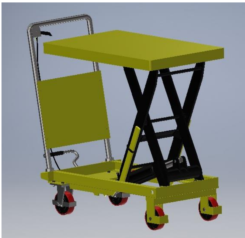
Slika 4.36. Krajnje izdignuti položaj platforme
