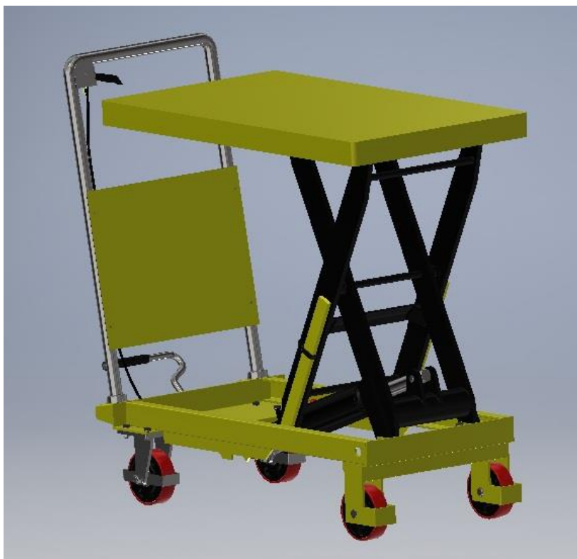
Slika 4.36. Krajnje izdignuti položaj platforme
