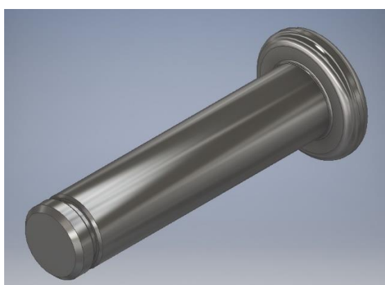
Slika 4.19. Svornjak \Phi 14 \times 65 mm
