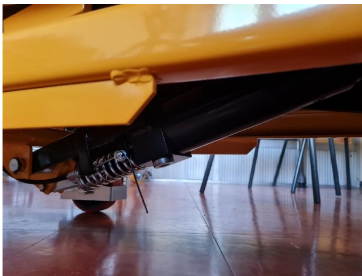
Slika 3.10. Hidraulička pumpa korištena na teretnim kolicima
