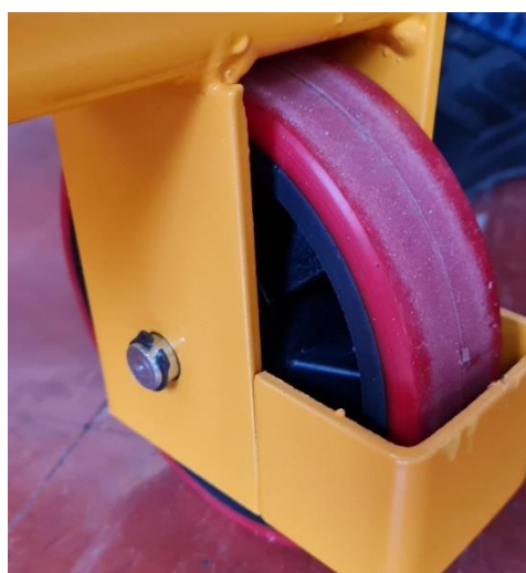
Slika 3.16. Osiguranje prednjih kotača
