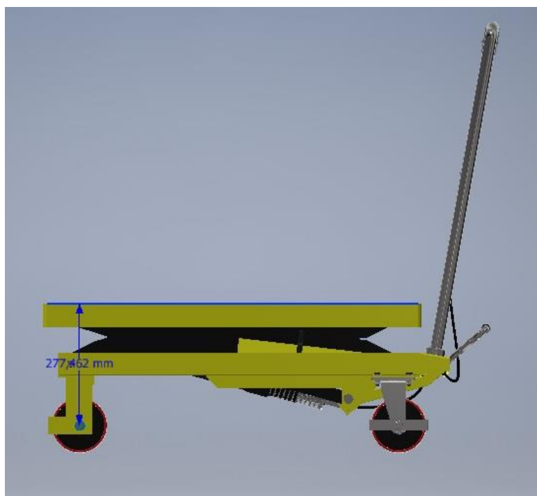
Slika 5.2. Visina platforme pri krajnje spušenom položaju
