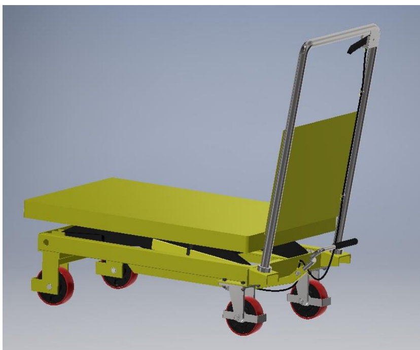
Slika 4.38. Krajnje spuštenu položaj platforme
