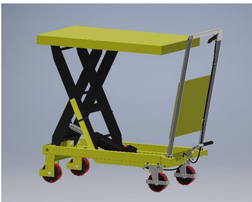
Slika 4.37. Krajnje izdignuti položaj platforme
