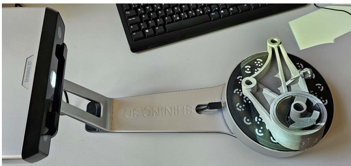
Slika 4.14 Skeniranje trećeg položaja nosača
