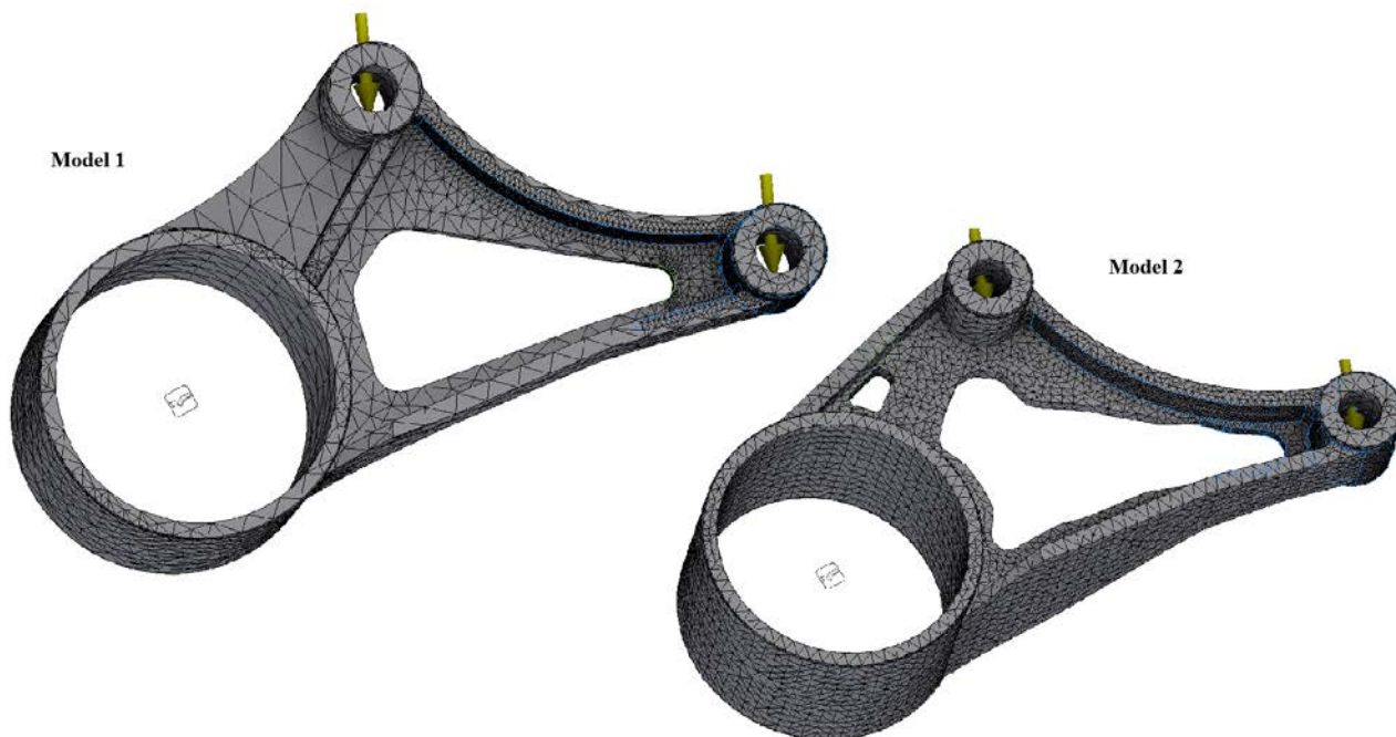
Slika 7.14 Lokalno izmijenjena mreža konačnih elemenata optimiranih modela
