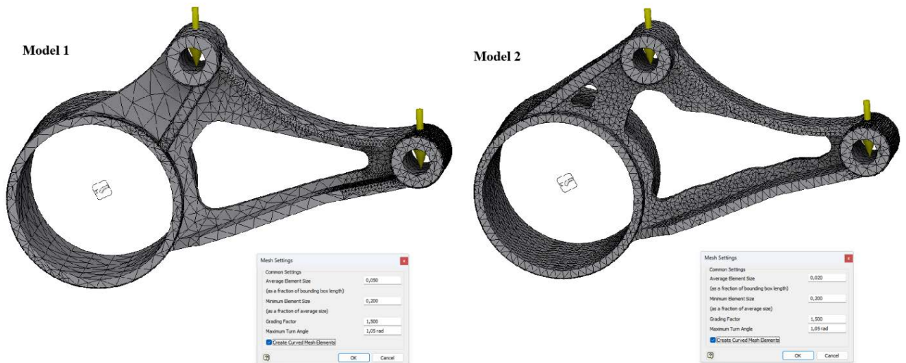
Slika 7.13 Definiranje postavki mreže optimiranim modelima
