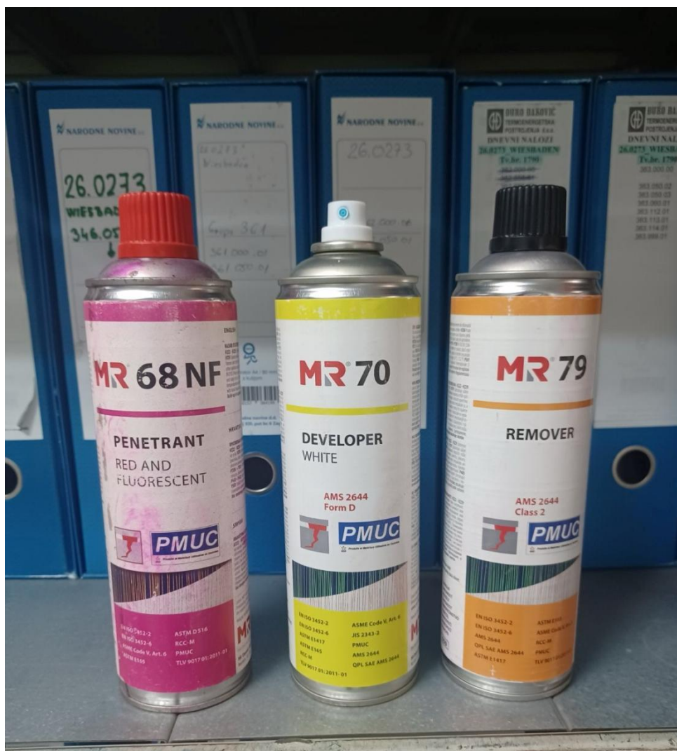
Slika 5.8. Penetrant, čistač i razvijач korišteni tijekom ispitivanja
