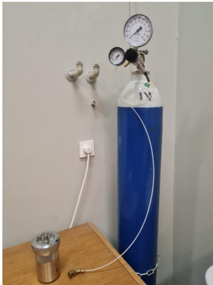
Slika 5.5 Definiranje tlaka kalorimetrijske bombe pomoću boce s kisikom
