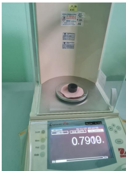
Slika 5.3 Mjerenje mase uzorka goriva
