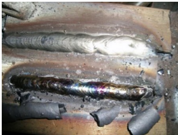
Slika 8.3. Pojava troske kod zavarenog spoja [46]
