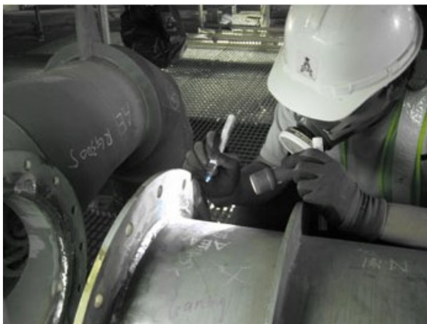
Slika 3.1. Vizualna metoda ispitivanja [5]
