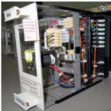
Slika 4.2. Elektromehanički relej u pogonu[12]
