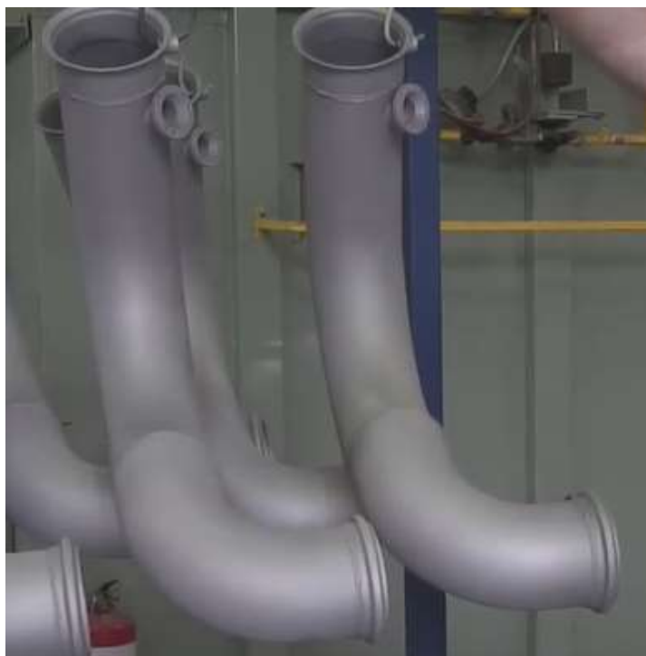
Slika 4.17 Cijevi nakon nanošenja keramičke prevlake [21]
