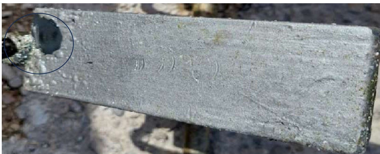
Slika 5.12 Uzorak sa završnom organskom bojom (bez međupremaza)
