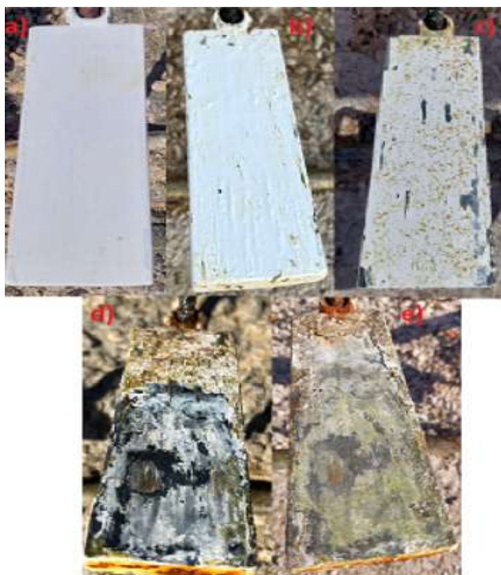
Slika 5.31 Uzorak 3 a) prije uranjanja, b) prvi pregled, c) drugi pregled, d) treći pregled, e) četvrti pregled
