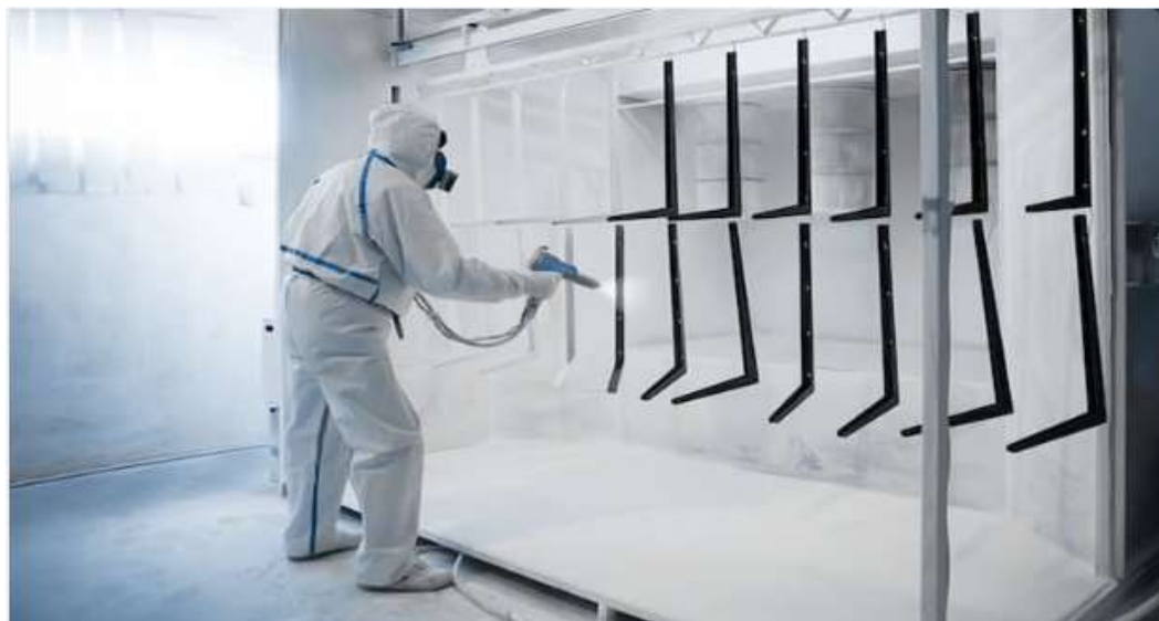
Slika 4.20 Nanošenje praha na metal [22]
