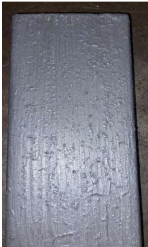
Slika 4.24 Primjer nekompatibilnog završnog premaza sa međupremazom
