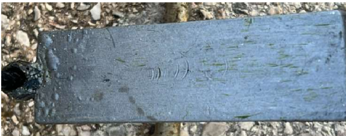
Slika 5.6 Uzorak sa završnom organskom bojom (bez međupremaza)
