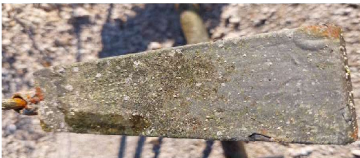
Slika 5.24 Uzorak sa završnom organskom bojom (bez međupremaza)
