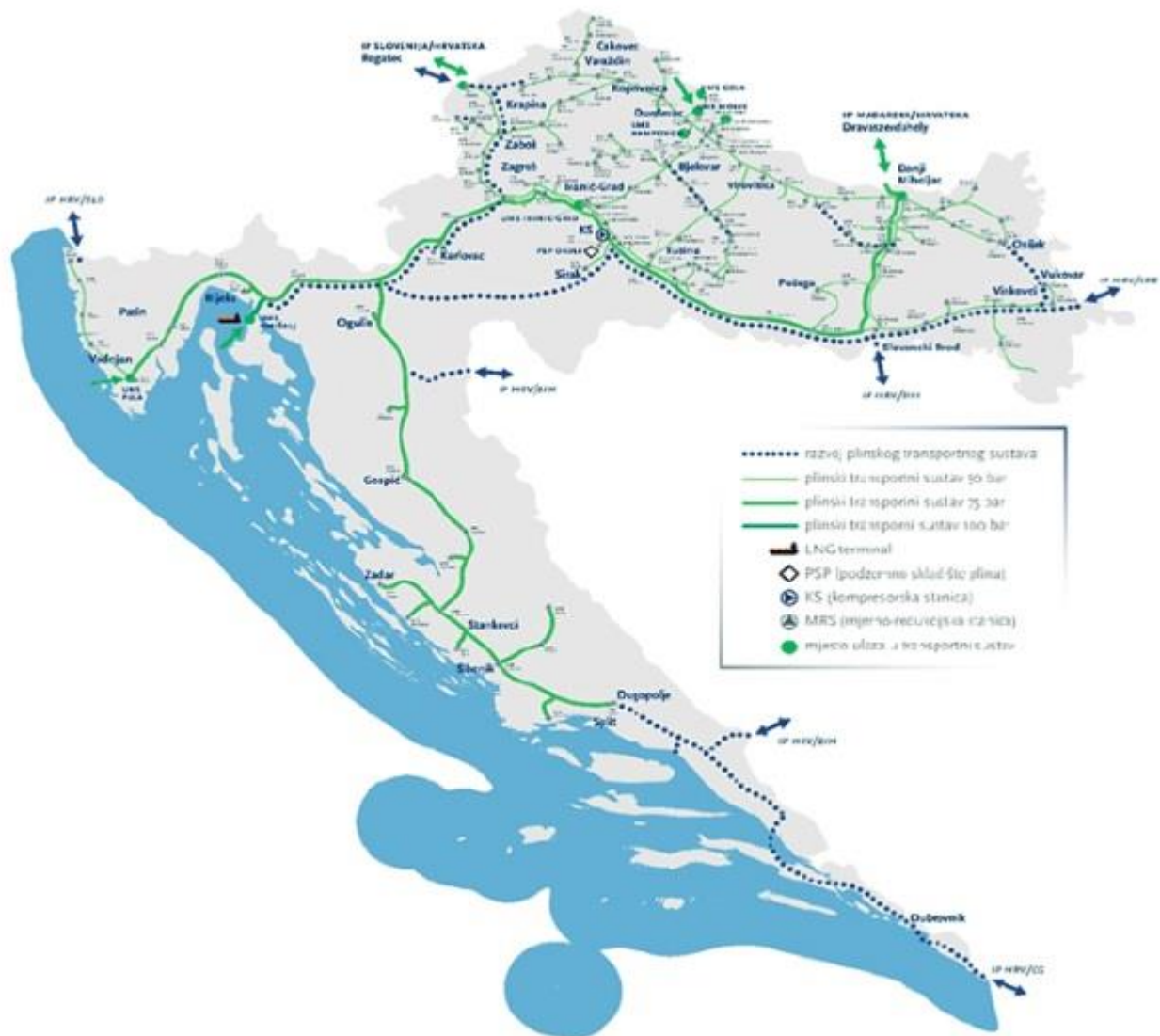
Slika 2.3. Plinski transportni sustav Republike Hrvatske [6]
