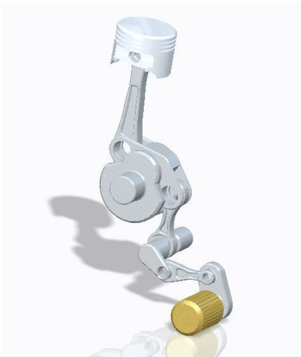
Slika 7.1 3D model sustava promjene kompresije
