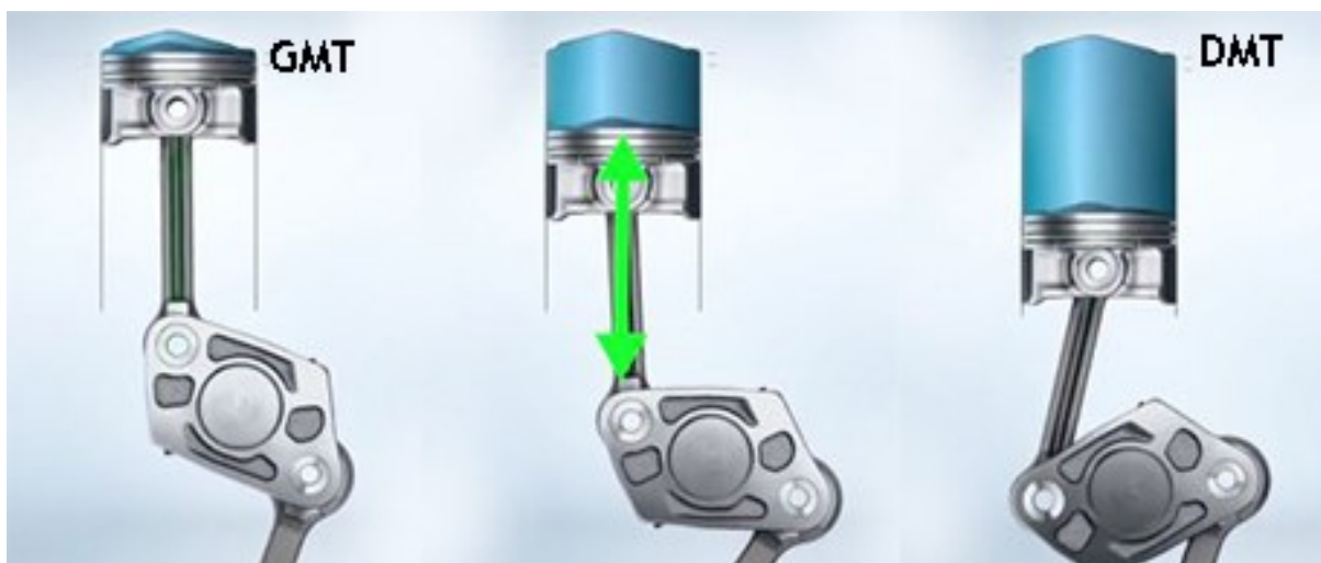
Slika 4.4. Kut ojnice kod motora s varijabilnim kompresijskim omjerom [8]
