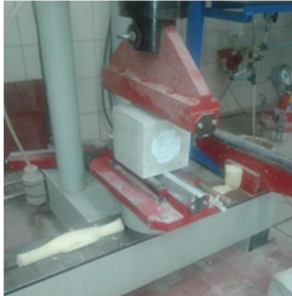
Slika 26 Ispitivanje vlačne čvrstoće betonskih kocki u laboratoriju
