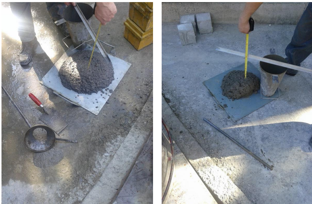
Slika 21 Mjerenje slijeganja pokusnih mješavina ( slump test )
