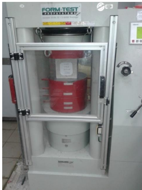
Slika 24 Ispitivanje tlačne čvrstoće betonskih kocki u laboratoriju
