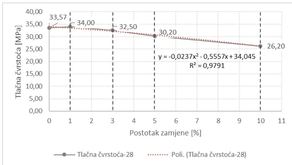
Slika 37 Rezultati tlačnih čvrstoća betona nakon 28 dana
