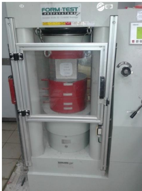
Slika 24 Ispitivanje tlačne čvrstoće betonskih kocki u laboratoriju
