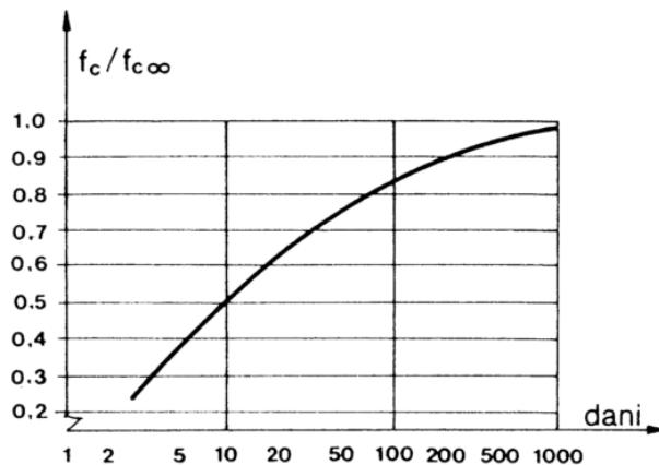
Slika 39 Promjena čvrstoće betona starenjem (Gukov, 2017)
