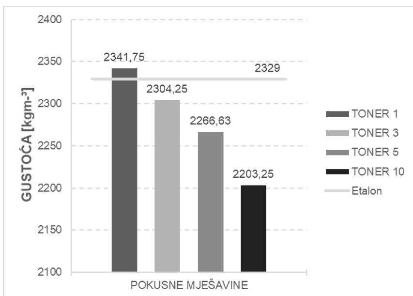
Slika 36 Rezultati mjerjenja gustoće svježih pokusnih mješavina betona sa i bez dodatka mješavine otpadnog tonerskog praha i kalcijevog karbonata
