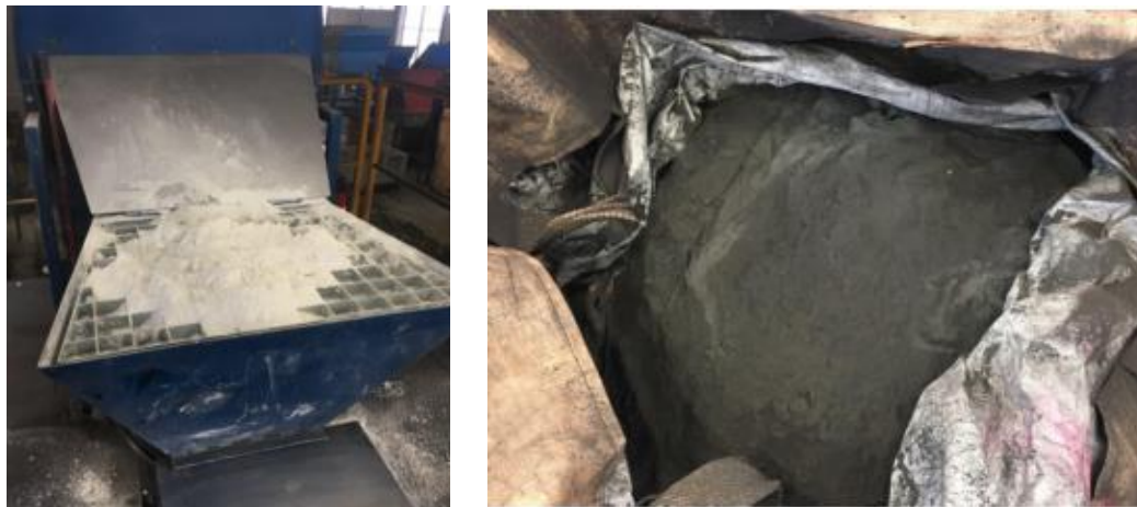
Slika 11 Umješavanje aditiva na početku obrade i mješavina korištena u istraživanju
