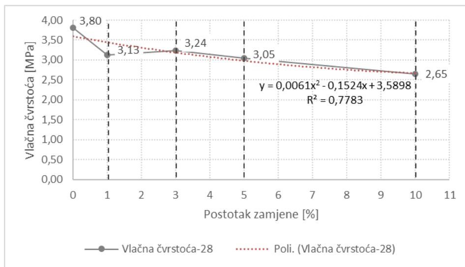
Slika 41 Rezultati vlačnih čvrstoća betona nakon 28 dana
