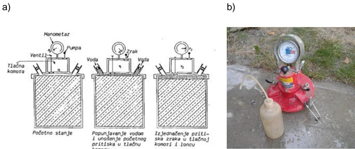
Slika 22 a) Porometar za svježi beton (Ukrainczyk, 1994); b) porometar korišten u istraživanju
