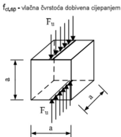
Slika 25 Princip ispitivanje vlačne čvrstoće cijepanjem (Gukov, 2011)
