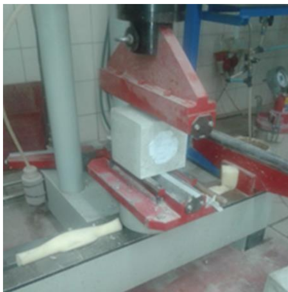
Slika 26 Ispitivanje vlačne čvrstoće betonskih kocki u laboratoriju
