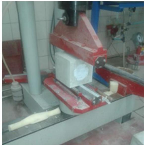
Slika 26 Ispitivanje vlačne čvrstoće betonskih kocki u laboratoriju
