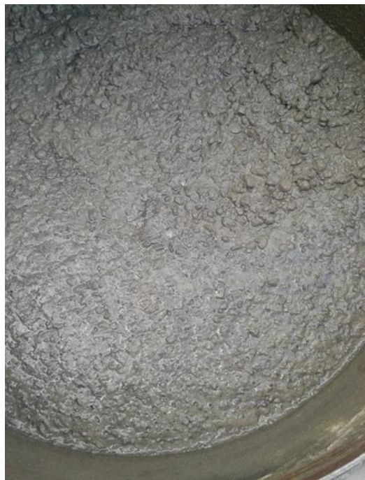
Slika 18 Prikaz pokusne mješavine s 1% zamjene (TONER 1)
