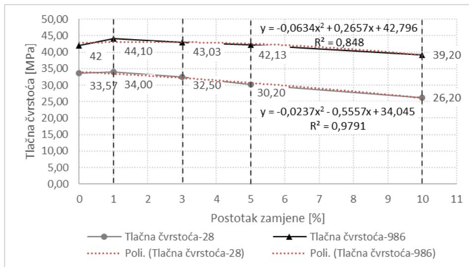
Slika 38 Usporedba tlačnih čvrstoća nakon 28 dana i 986 dana
