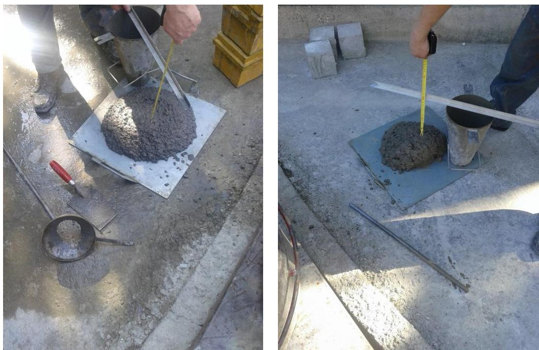
Slika 21 Mjerenje slijeganja pokusnih mješavina (*slump test*)
