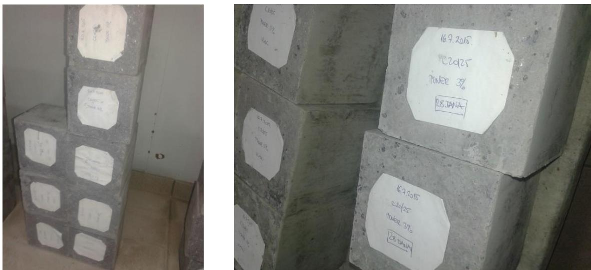
Slika 23 Njegovanje betonskih testnih kocki u vlažnoj komori
