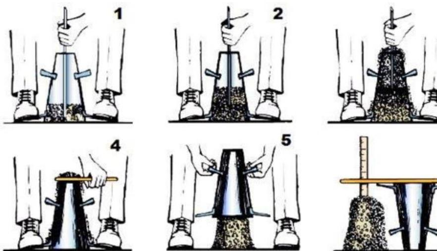
Slika 20 Ispitivanje svježeg betona slijeganjem (*slump test*) (Nekić, 2017)
