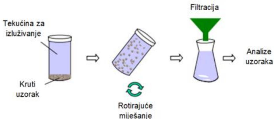
Slika 14 Shematski prikaz izluživanja prema normi HRN EN 12457-2:2005 (Nakić et al., 2017)
