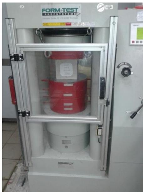
Slika 24 Ispitivanje tlačne čvrstoće betonskih kocki u laboratoriju
