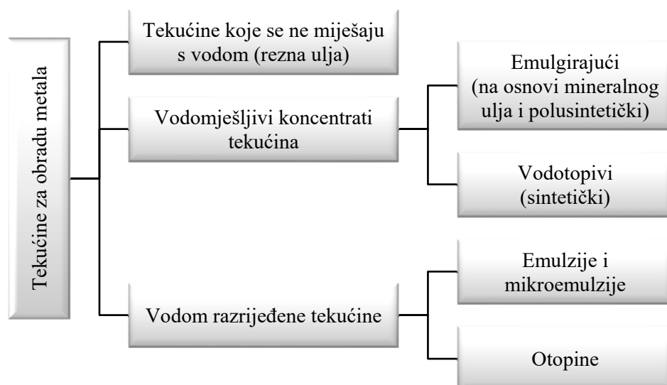
Slika 2.5. Klasifikacija tekućina za obradu metala prema DIN 51385:2013
