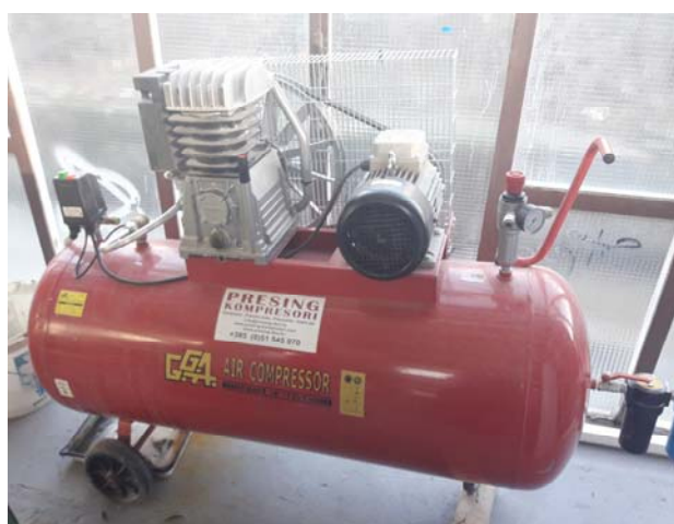
Slika 5.7. Klipni kompresor Presing B7000
