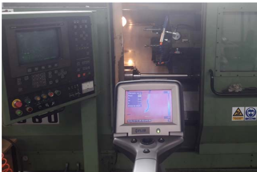
Slika 5.13. Termovizijska infracrvena kamera ThermoCAM S65
