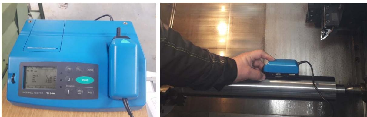
Slika 5.11. Profilometar Hommel Tester T1000 i mjerjenje hrapavosti obrađene površine
