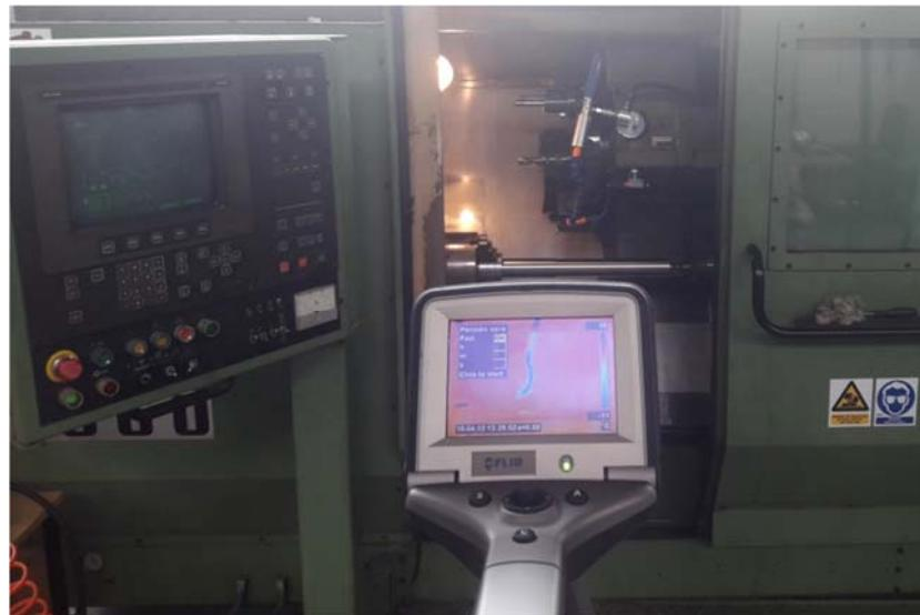
**Slika 5.13.** Termovizijska infracrvena kamera ThermaCAM S65
