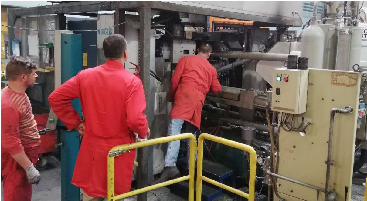
Slika 6.26: Dodavanje točnih odvaga MWCNT ispred klipa za pripravu nanokompozita s različitim udjelima ojačala
