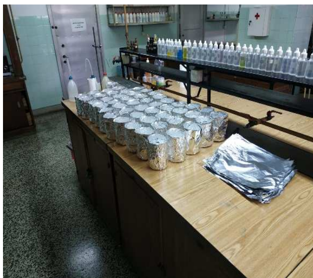
Slika 6.24: a-c) Postupak vaganja MWCNT i pakiranja istih u Al-foliju proveden je na Metalurškom fakultetu u Sisku; d) pripremljeni paketi MWCNT u kojima je m (MWCNT u Al-foliji po paketu) = 50g
