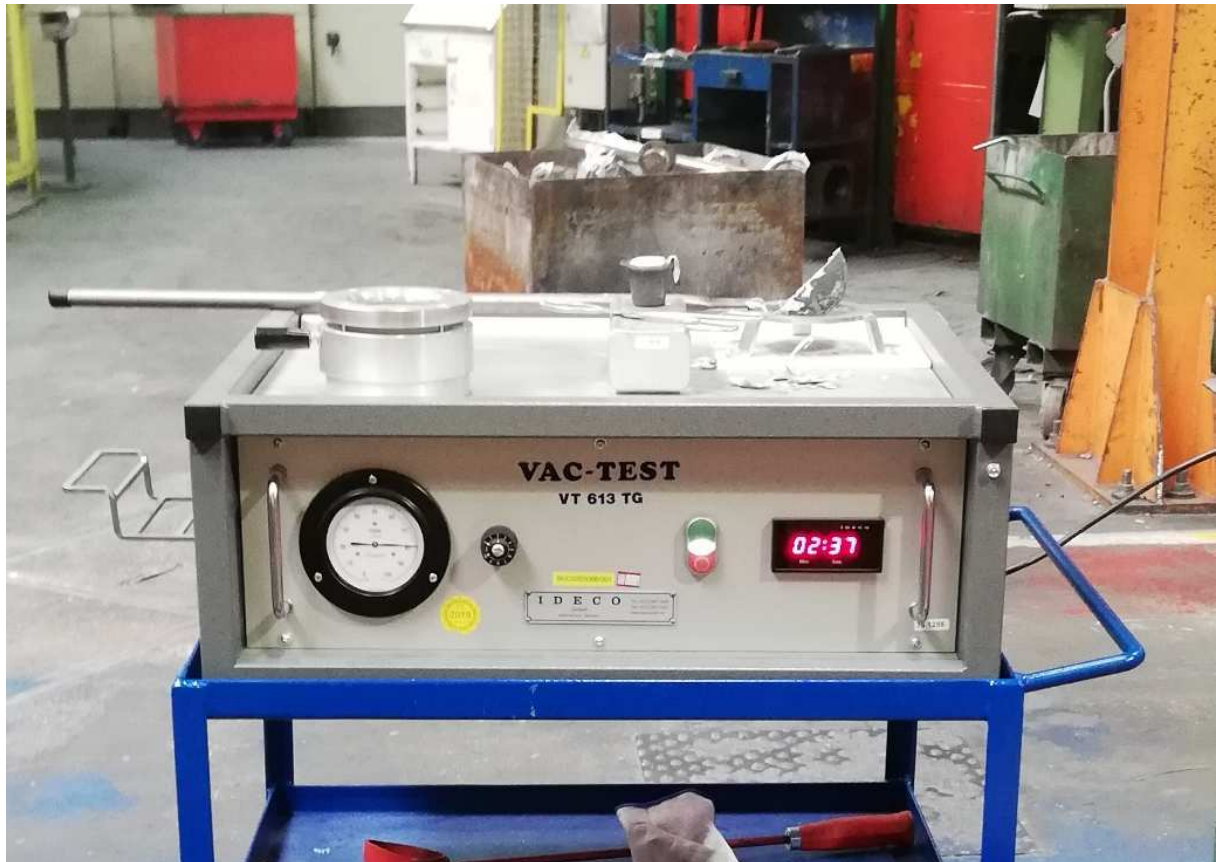
Slika 6.29: Vakuum test ispitivanja naplinitosti magnezijem dolegirane taljevine/legure AlSi9Cu3(Fe) pri 80 mbara tijekom 4 minute
