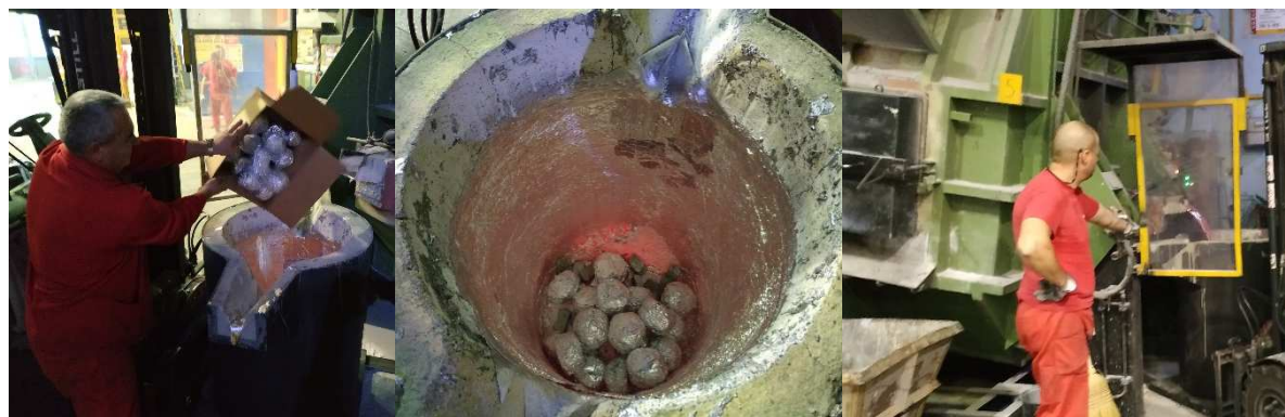
Slika 6.25: Dodavanje magnezija i MWCNT u lonac te dodavanje taljevine Al-legure
