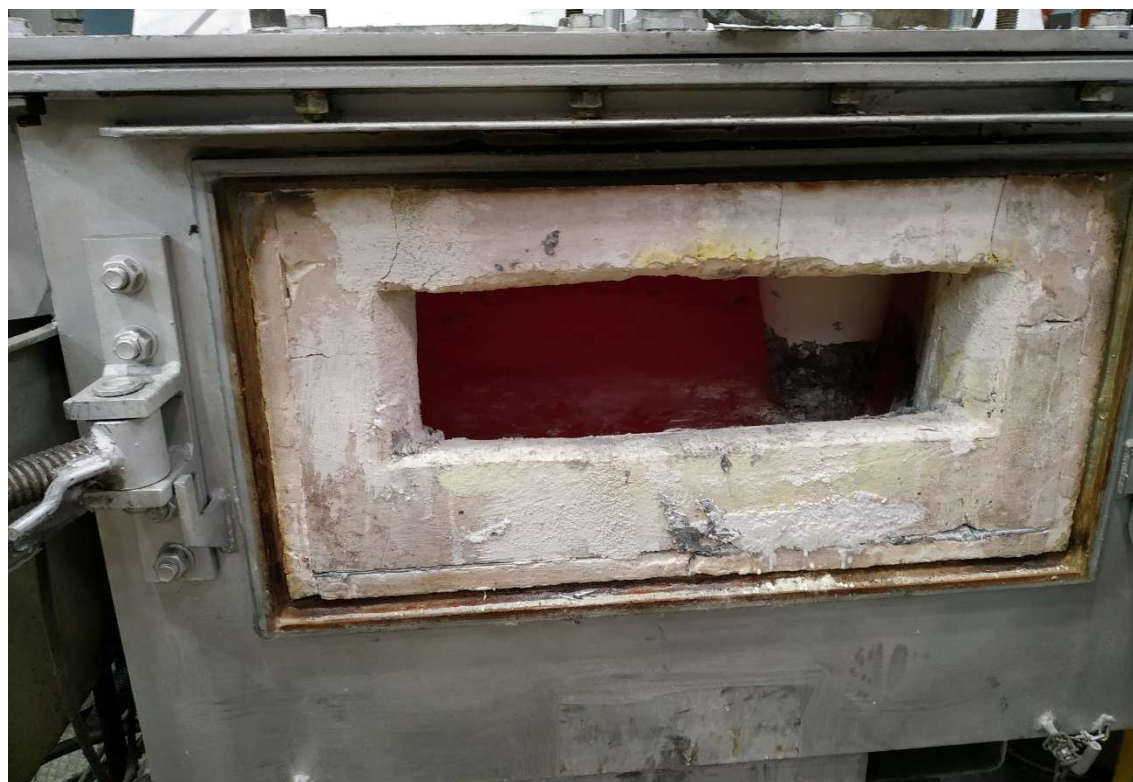
Slika 6.27: Peć s taljevinom pripremljenom od AlSi9Cu3(Fe) legure (dolegirane magnezijem) - otvor na peći za uzorkovanje za kontrolu kvalitete
