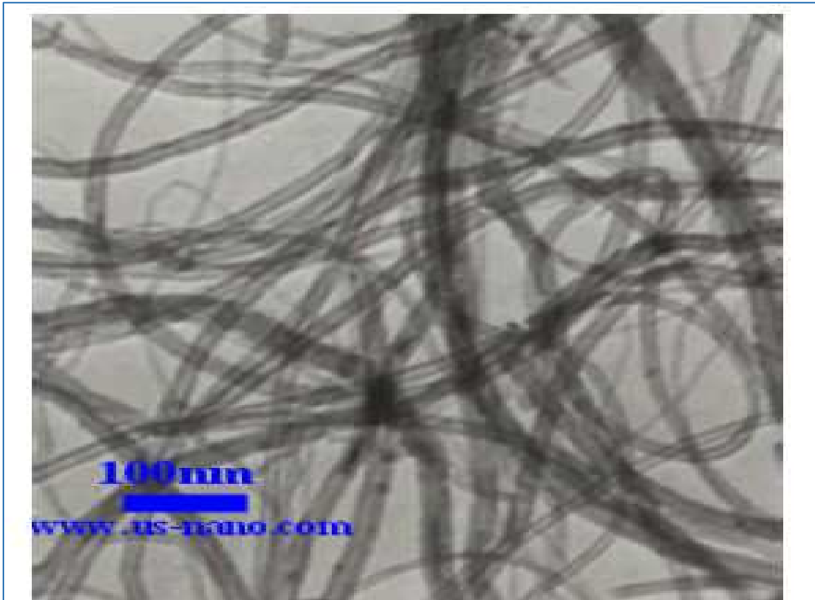
Slika 6.13: SEM slika MWCNT istaknuta na ambalaži
