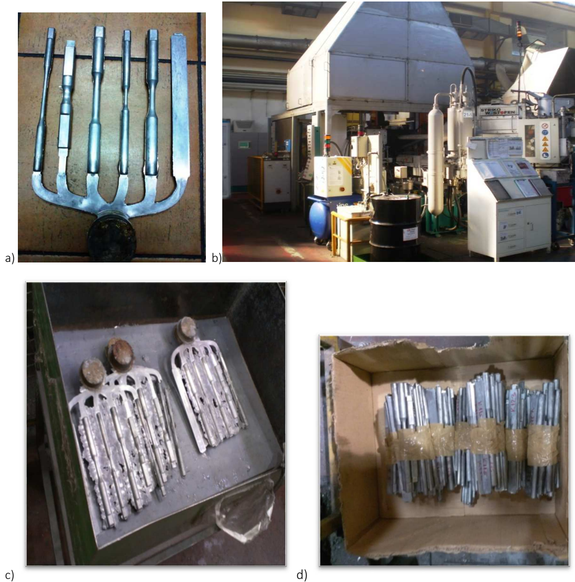
Slika 6.17: a) Lijevani grozd sa šest epruveta za mehanička ispitivanja prema normi ISO 377; b) kompletna ćelija za visokotlačno lijevanje BUHLER-42D; c) epruvete tek izvađene iz alata, d) epruvete razdvojene i pripremljene za mehanička ispitivanja
